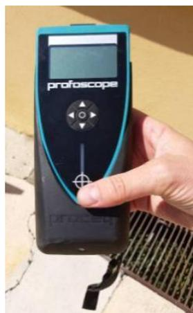
**Figura 2.0.19 il pacometro Profoscope + utilizzato nelle indagini**
