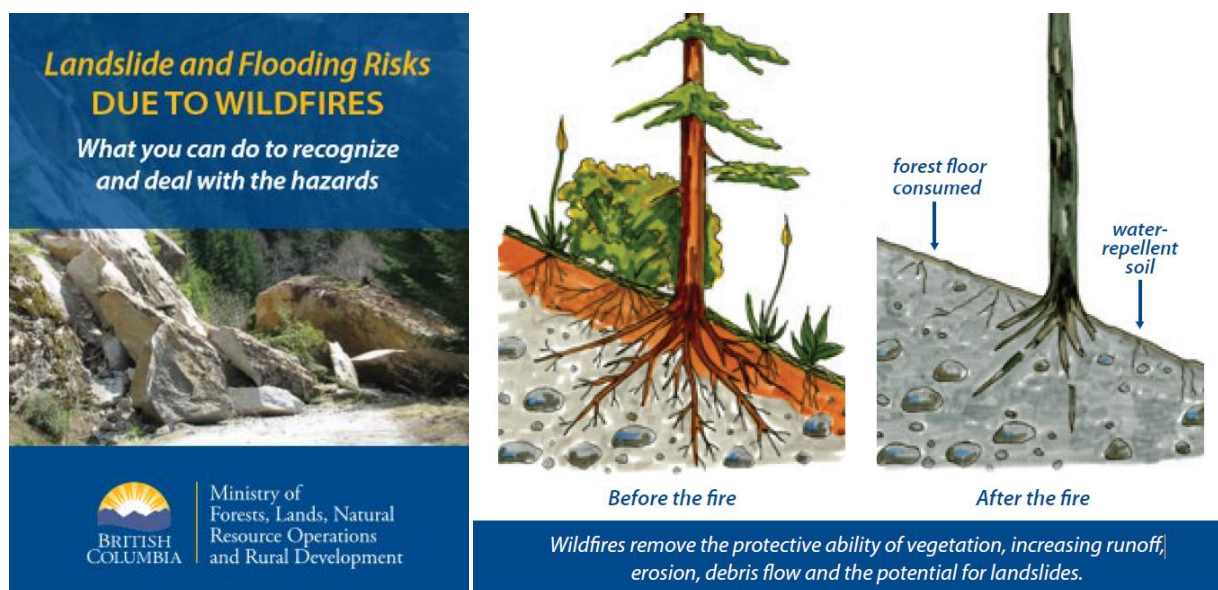
Figura 4: mutamento del terreno e della vegetazione a seguito di un incendio (British Col. pamphlet)
