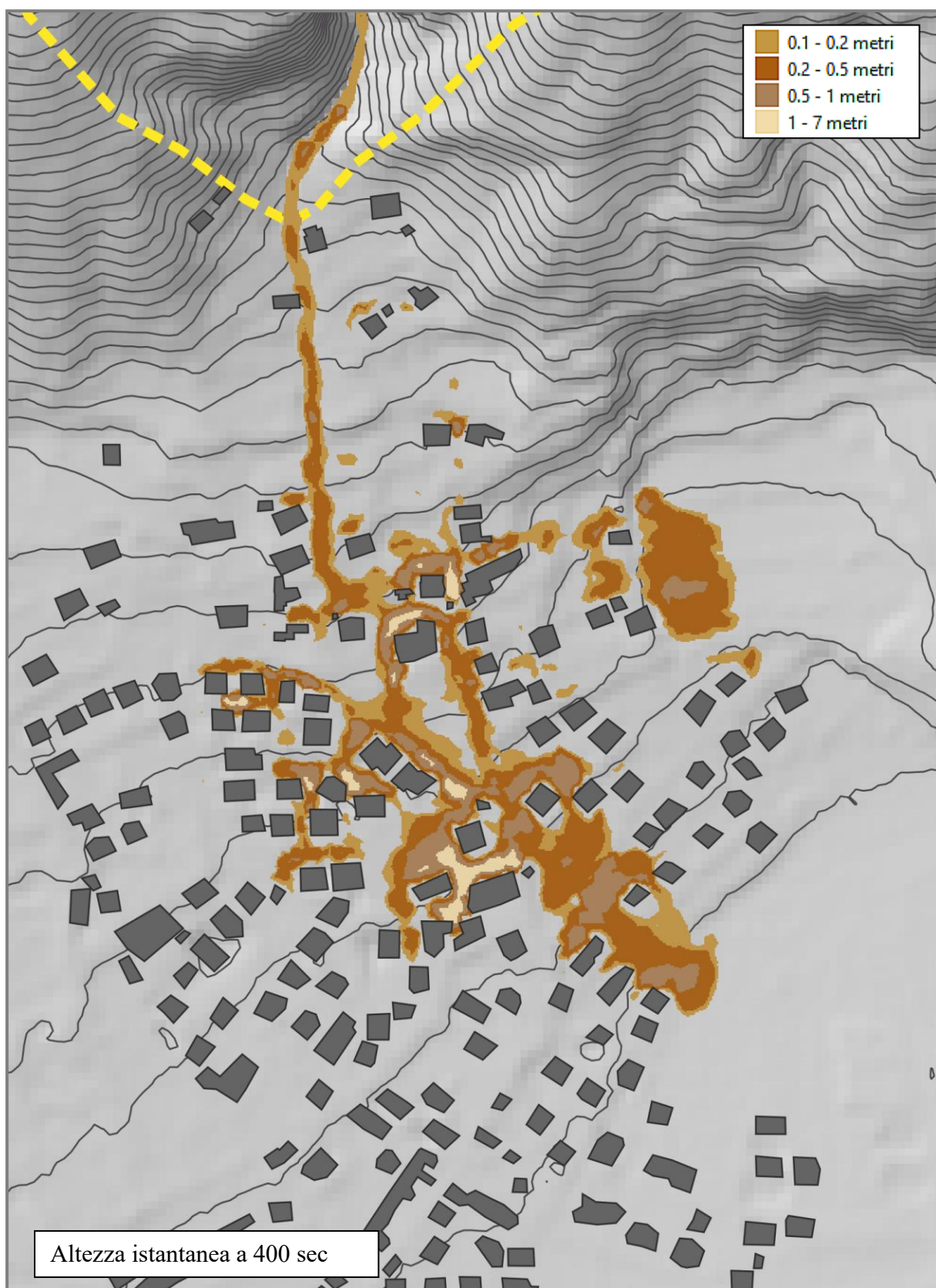
Figura 86: risultato della simulazione con attrito 2,86^\circ e turbolenza 500 \text{ m/s}^2 , modello C_B_S. Altezze istantanee del deposito al tempo 400 secondi. Cut-off inferiore a 10 cm.
