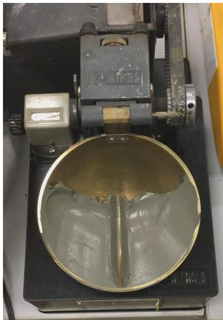
*Figura 2.6. Prova con il Cucchiaino di Casagrande per la determinazione del limite liquido.*
