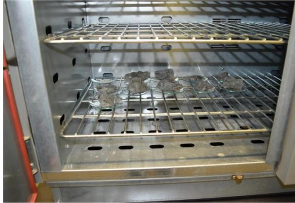
Figura 2.3. Essiccazione in un forno alla temperatura di 100°C per circa 24 ore.
