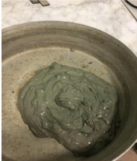
*Figura 2.5. Preparazione del materiale per la determinazione del limite liquido.*
