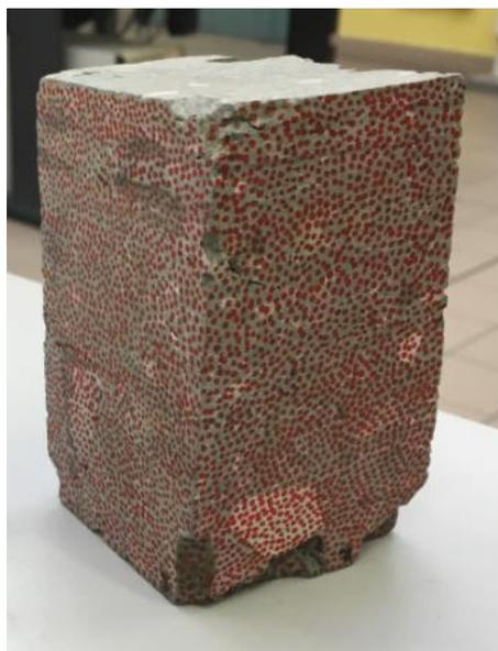
*Figura 4.1. Pattern di punti realizzato su un campione di mélange per l'analisi con la tecnica DIC (Digital Image Correlation).*
