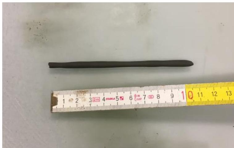
Figura 2.8. Prova per la determinazione del limite plastico.
