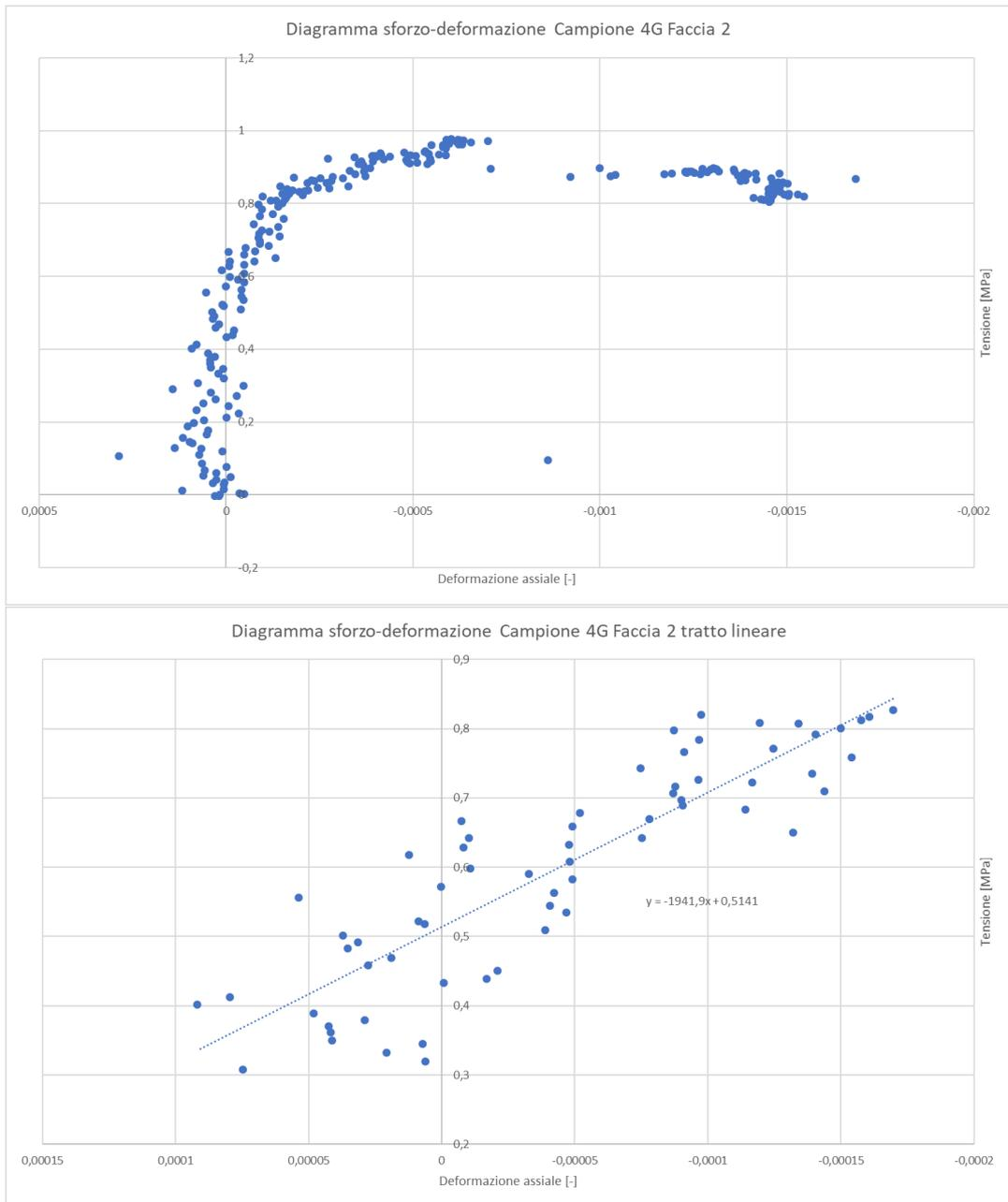
Figura 4.30. Diagrammi Sforzo-Deformazione ottenuto dai dati ricavati dalla tecnica DIC (Faccia 2, Campione 4G).
