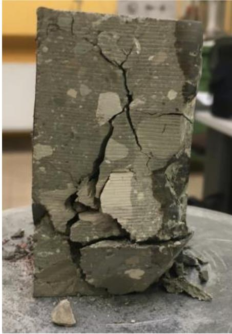
*Figura 4.36. Formazione di una frattura principale verticale che segue la tortuosità delle inclusioni (Campione 3).*
