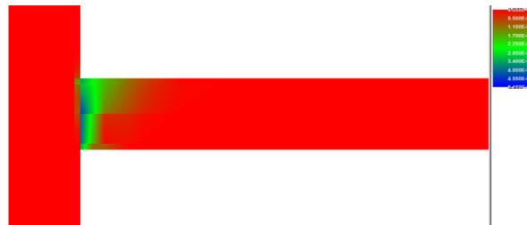
Figura 53: Esempio di deformazione totale principale nel calcestruzzo
