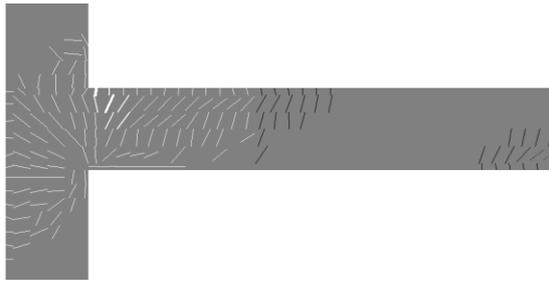
Figura 51: Esempio di stato fessurativo del calcestruzzo
