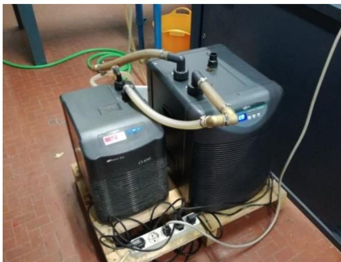
Figura 5.15: Scambiatori di calore in serie adottati nel sistema di raffreddamento dell'impianto sperimentale [7].
