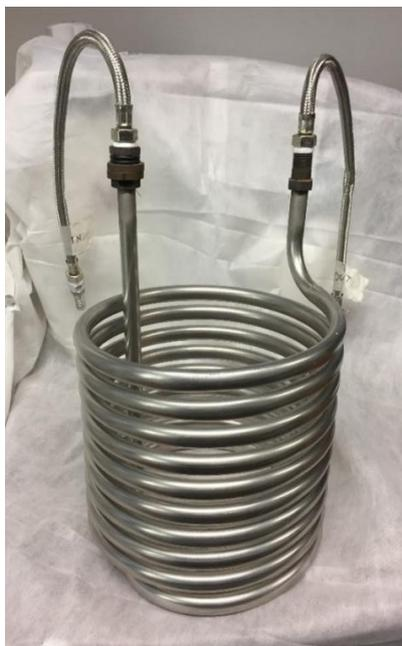
**Figura 5.16:** Serpentina metallica per lo scambio termico.
