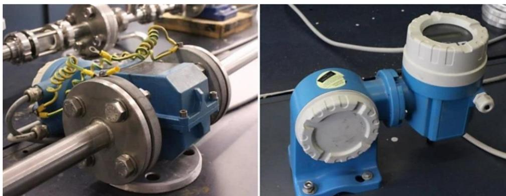
Figura 5.7: Misuratore elettromagnetico di portata (destra) e relativo display (sinistra) [7].
