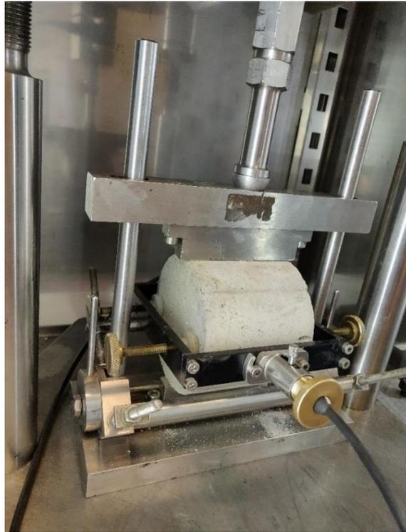
Figura 4.8: Esempio di settaggio ITSM.
