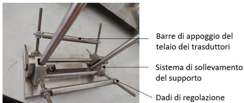
Figura 4.7: Sistema di barre a V.
