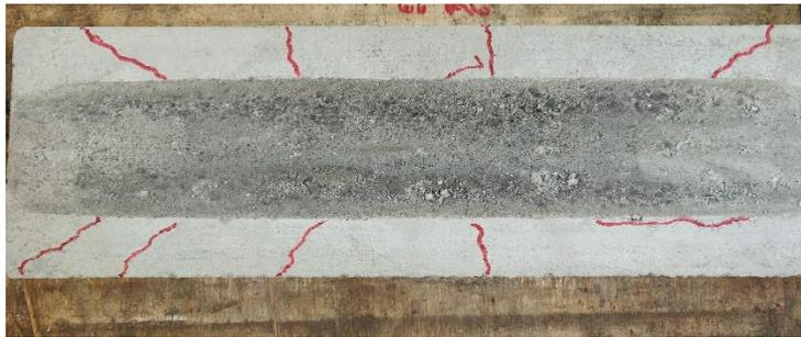
Figura 5.20: Differenza a fine prova trave con percentuale di cemento pari a 60kg/m<sup>3</sup>
