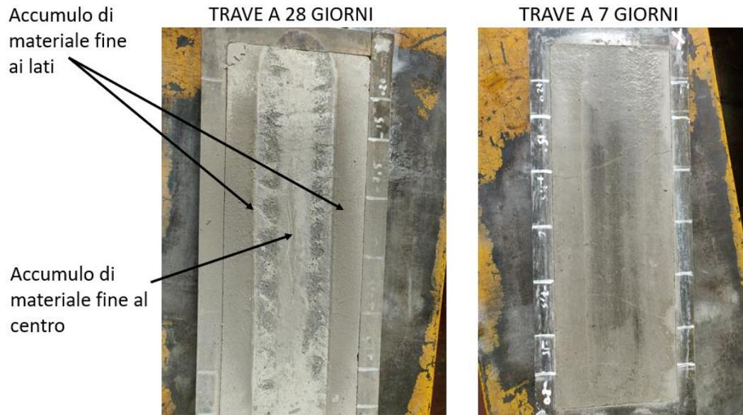
Figura 5.21: Diverso comportamento trave a  $100\text{kg}/\text{m}^3$  con tempo di maturazione di 28 giorni rispetto a 7.
