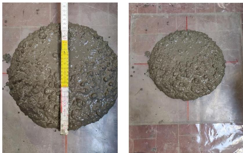
Figura 4.3: Prova a spandimento campioni a 100 e a 60 kg/m<sup>3</sup> di cemento.
