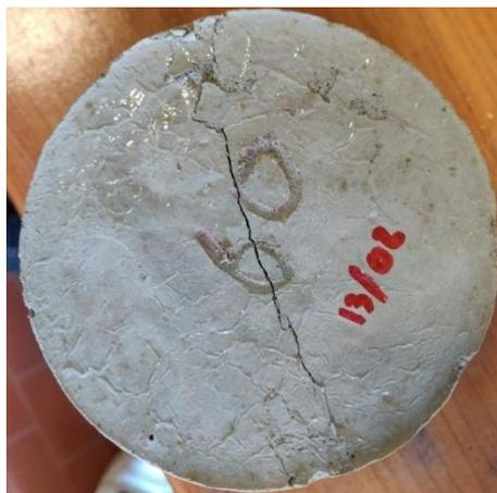
Figura 5.10: Esempio di campione rotto a 60 kg/m<sup>3</sup> e tempo di maturazione pari a 7 giorni.
