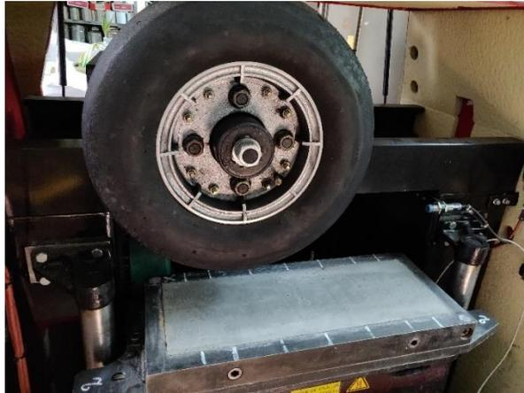
Figura 4.14: Settaggio prova a deformazioni permanenti.
