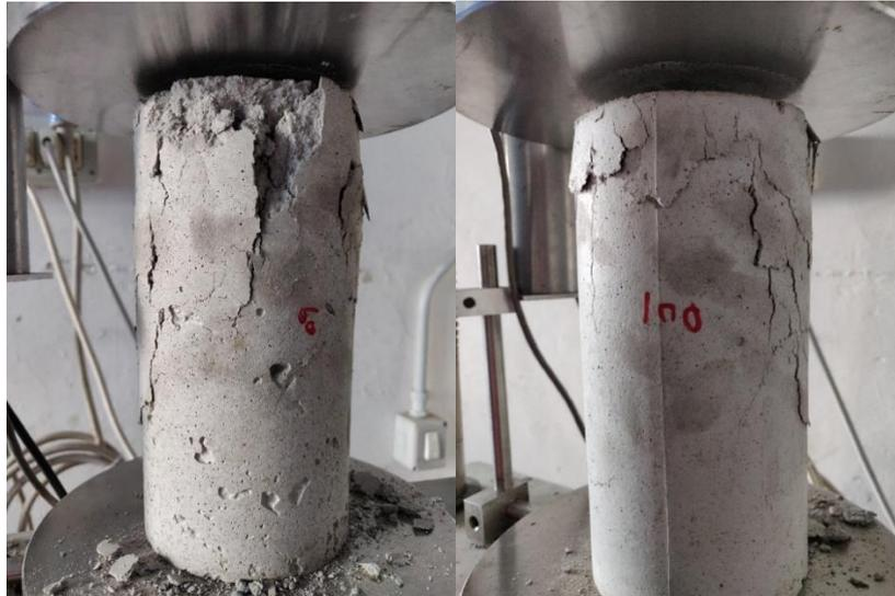
Figura 4.4: Esempi di rottura UCS campioni a 100 e a 60 kg/m<sup>3</sup> di cemento.
