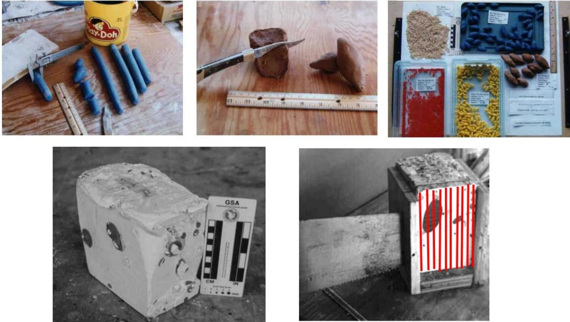
*Figura 21: Immagini relative al processo di fabbricazione e di analisi dei provini artificiali di Franciscan mélange (Medley, 1994).*
