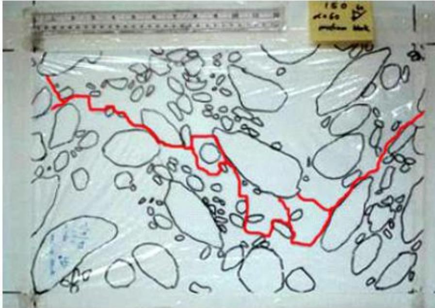
*Figura 27: Proiezione su pellicola trasparente della superficie laterale di un provino soggetto ad una prova triassiale, nella quale viene riportata in rosso la traccia della superficie di rottura (Lindquist, 1994)*
