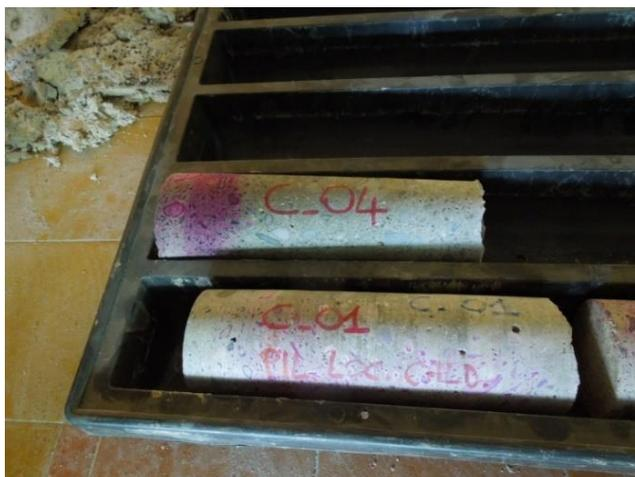
Figura 27 - Dettaglio carote estratte con segno della prova di carbonatazione
