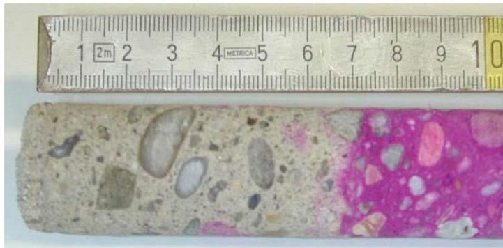
Fig. 2. 7. Test colorimetrico con Fenolftaleina.
