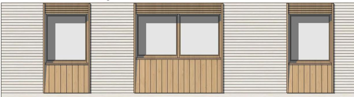
Figura 8.15 Pannello prefabbricato con il sistema Tes
