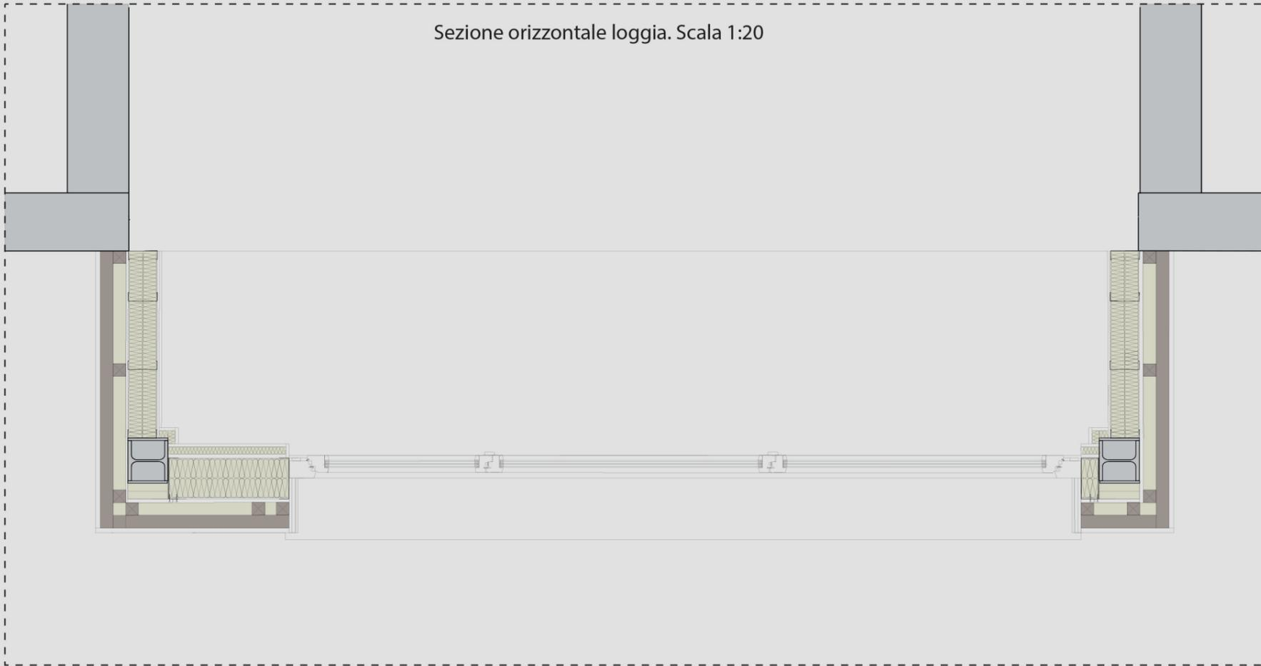
La struttura è costituita da una singola orditura di profili metallici in acciaio zincato di spessore 10mm, sezione 50-200-50mm, passo 600mm, inseriti dentro guide superiori ed inferiori di sezione 40-200-40mm. I profili di base vengono isolati dalle strutture esistenti con una guaina in polietilene impermeabile di spessore di 3 mm.
