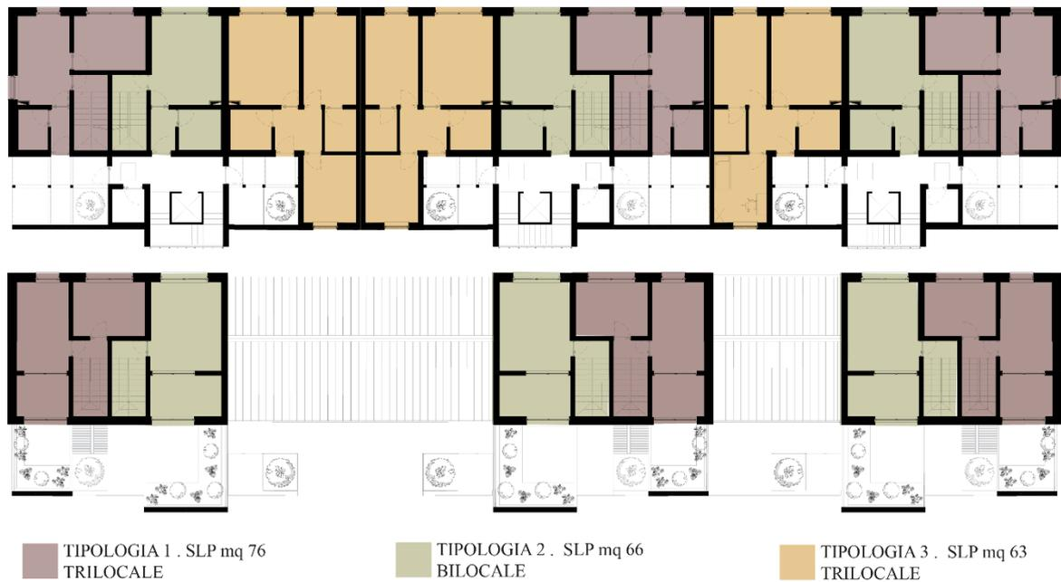
Figura 7.2 Tipologia di alloggi per Tipologia edilizia B, In alto riferite al primo livello della sopraelevazione ed in basso al secondo livello della sopraelevazione
