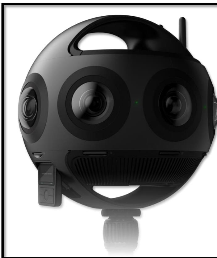
Figura 3 - Camera omnidirezionale Insta360 Titan
