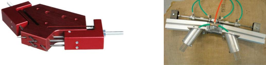
Figura 9. Esempi di Ingressive Gripper
