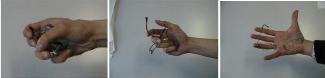
Figura 46. un occhiale realizzato in SMA che viene severamente deformato e che recupera la forma iniziale all'atto della rimozione della sollecitazione
