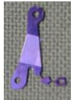
Il prototipo del gripper a tre dita proposto è mostrato in Figura 68. Sono stati utilizzati fili Flexinol della Dynalloy Inc. si diametro 250  $\mu\text{m}$  e lunghezza 11, 2 mm.
