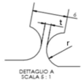
La Figura 93 illustra il modello 2D del gripper e il particolare della cerniera flessionale.
