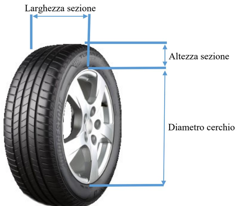
Figura 24 - Misure pneumatico
