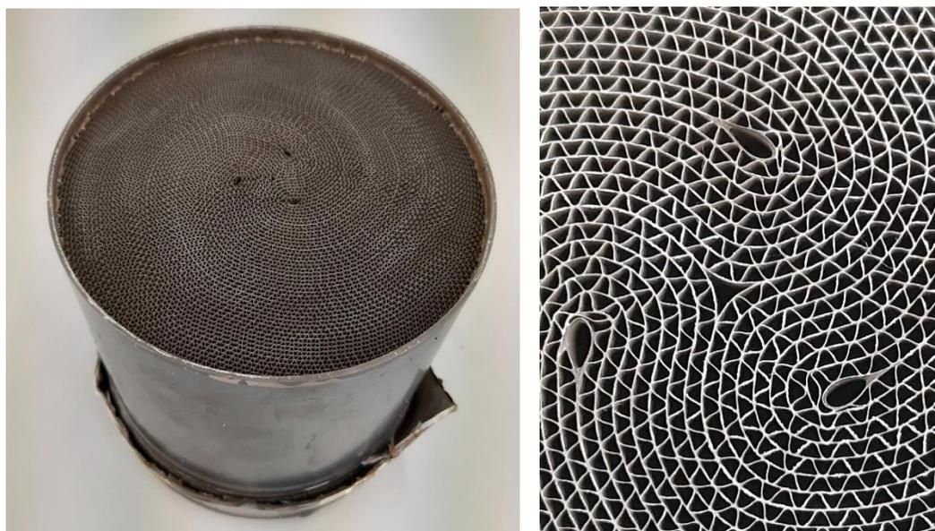
*Figura 9-14 – Struttura interna del catalizzatore trivalente*
