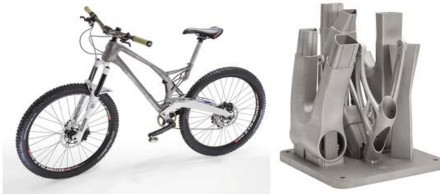
Figura 8-7 – Telaio di bicicletta prodotto da *Renishaw* e *Empire Cycle* con FA (Fonte: *Renishaw.com*)
