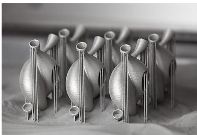
Figura 6-4 – Particolari prodotti mediante L-PBF (Fonte: Renishaw.com)
