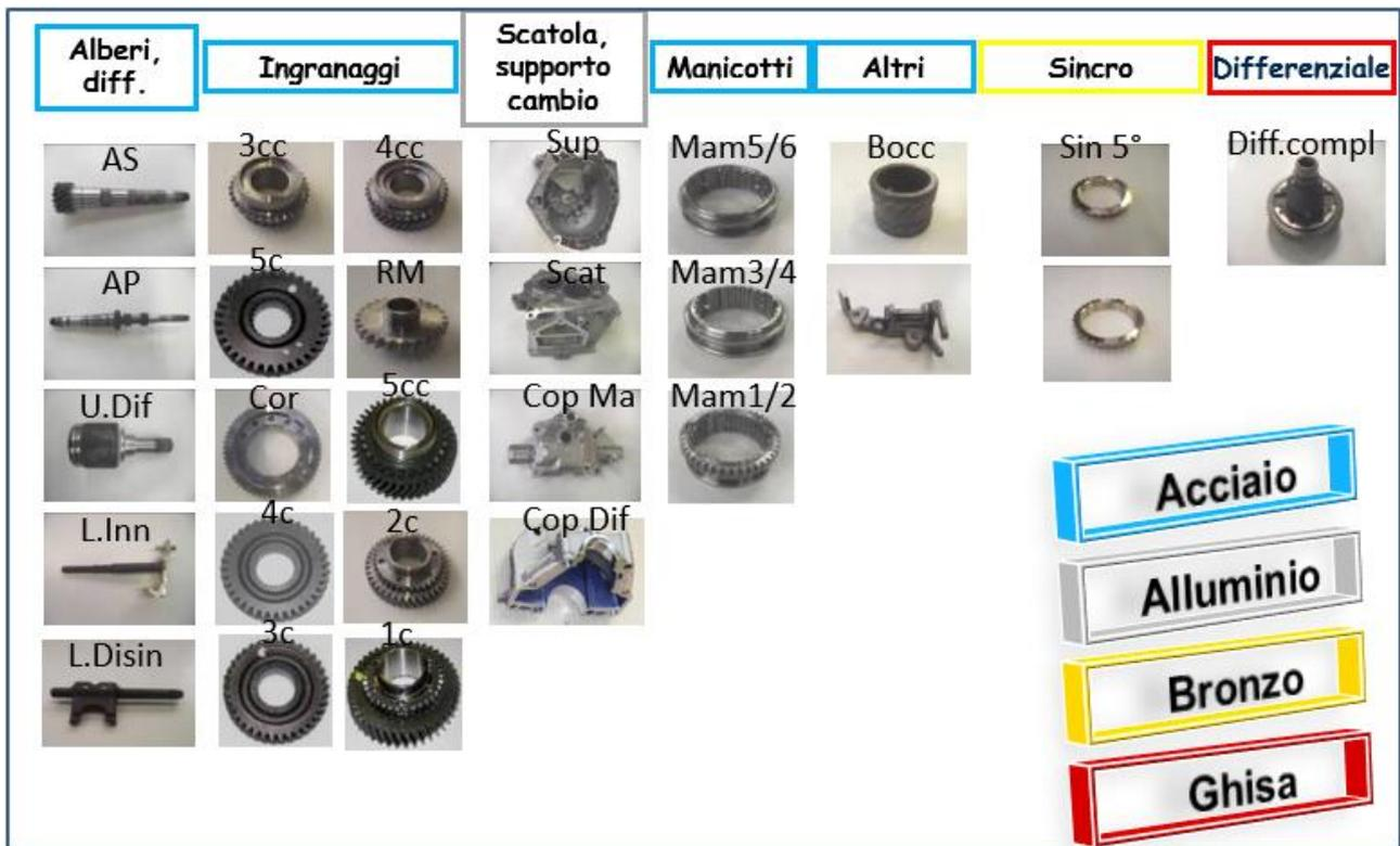
Figura 33: componenti cambio C514
