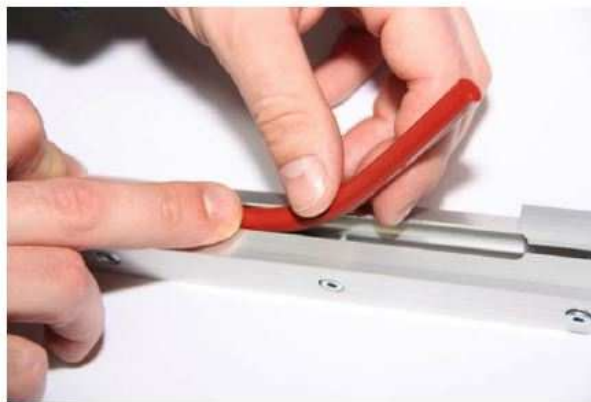
Figura 77: Inserimento della lama in silicone all'interno del recoater [11]
