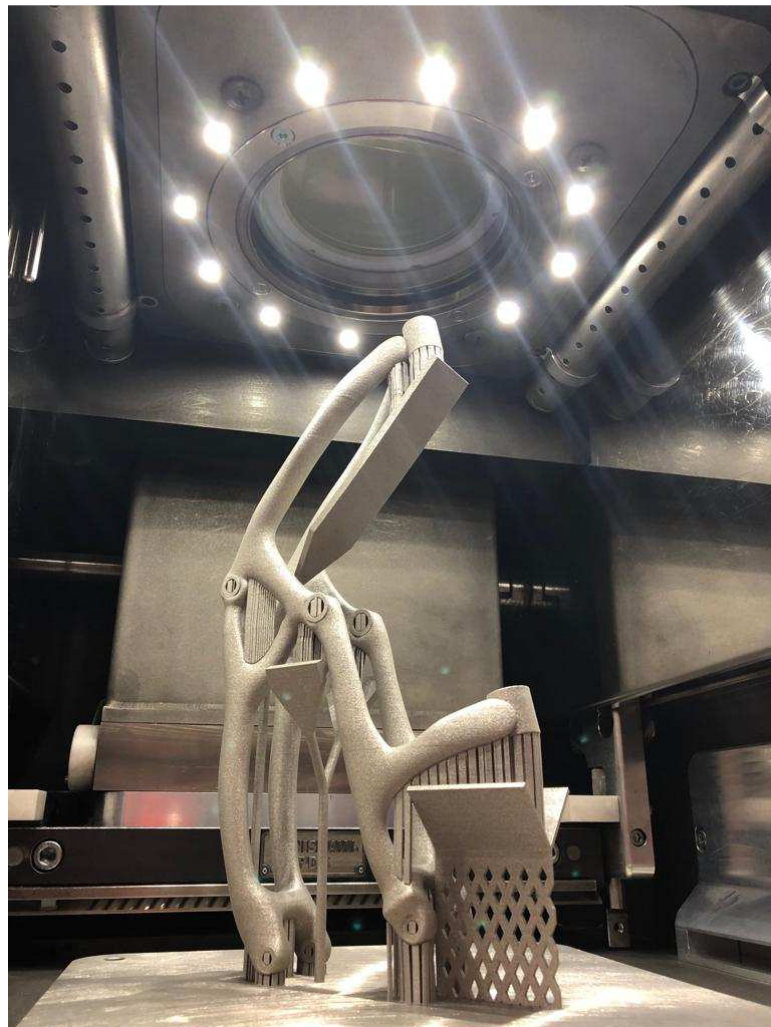
Figura 78: Risultato ottenuto dalla lavorazione; foto scattata con il build all'interno della camera di processo. Si nota sul soffitto della camera la finestra protettiva del sistema di ottiche
