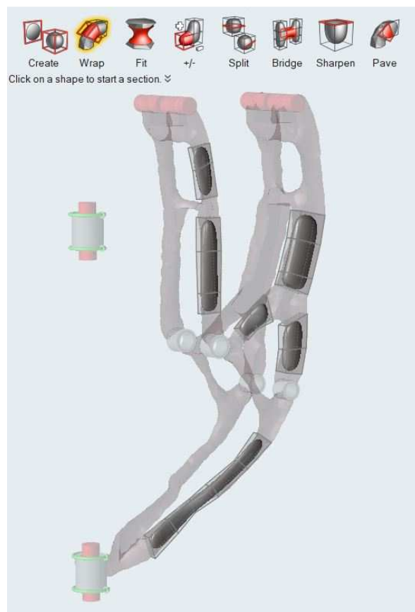
Figura 59: Realizzazione delle Nurbs seguendo il profilo del risultato definito dall'ottimizzazione
