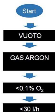
Figura 22: Ciclo di inertizzazione della camera [9]
