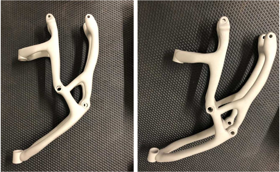
Figura 80: Foto del componente dopo aver subito la post-lavorazione di sabbiatura
