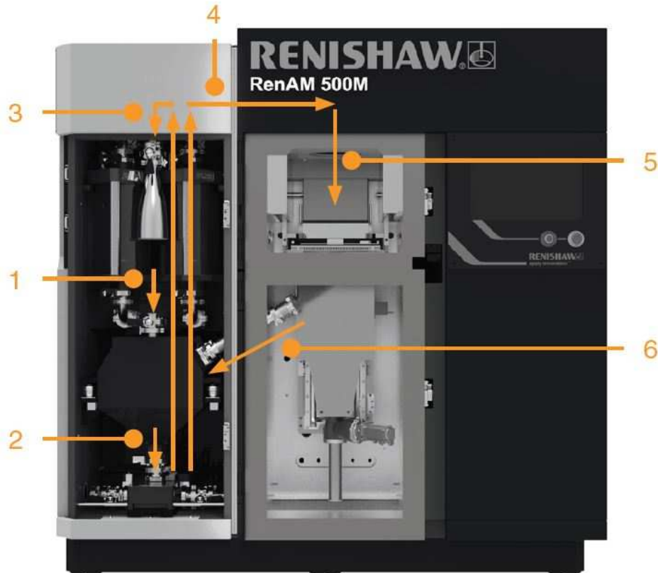
Figura 25: Ciclo di trasferimento pneumatico della polvere [11]
