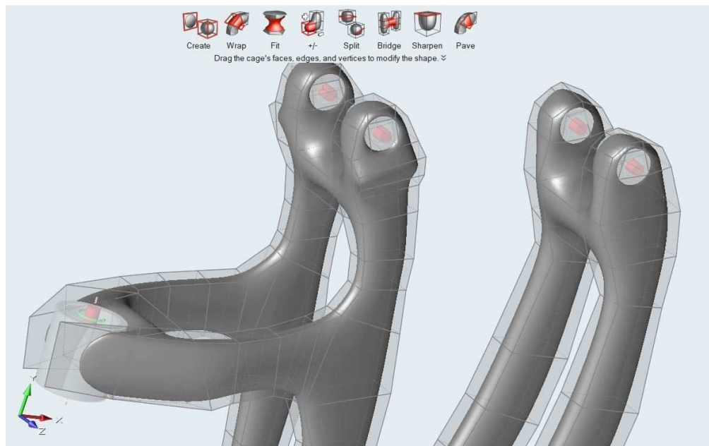
Figura 62: Creazione e modellazione delle superfici in prossimità dei fori di fissaggio per la barra del timone
