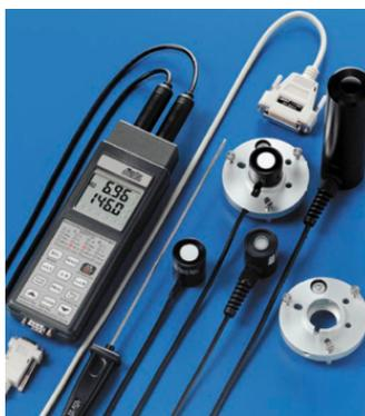
Figura 45: Foto/radiometro utilizzato più vari sensori.
