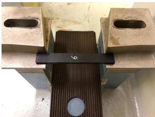
Figura 54: Disposizione del provino sui supporti (1).
