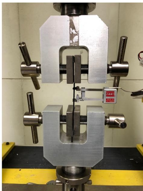
Figura 52: Posizionamento del provino tra le due morse e dell'estensimetro.
