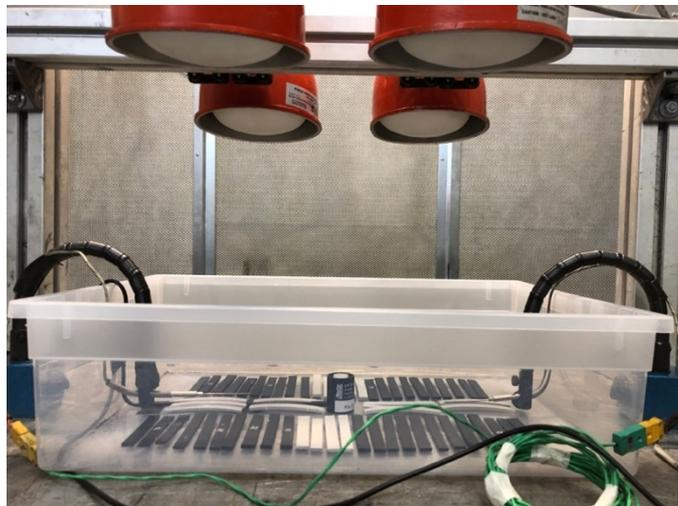
*Figura 42: Banco per l'invecchiamento tramite UV (vista 3).*
