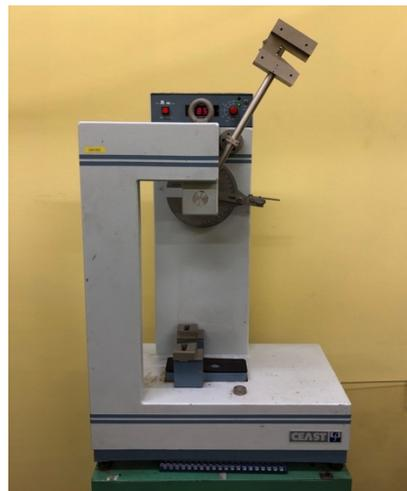
Figura 53: Macchinario per prova di resilienza Charpy.
