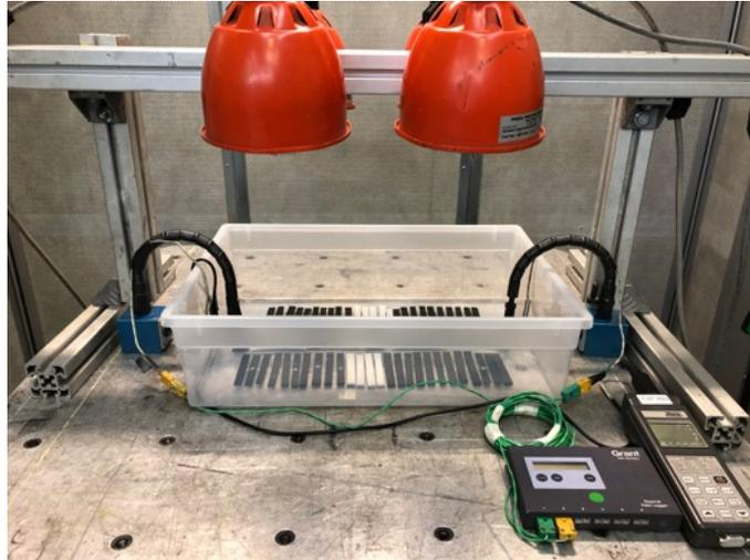
*Figura 40: Banco per l'invecchiamento tramite UV (vista 1).*
