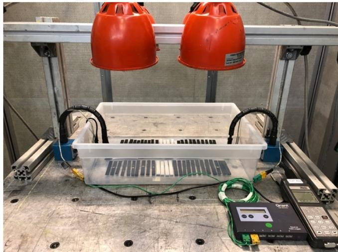
*Figura 41: Banco per l'invecchiamento tramite UV (vista 2).*
