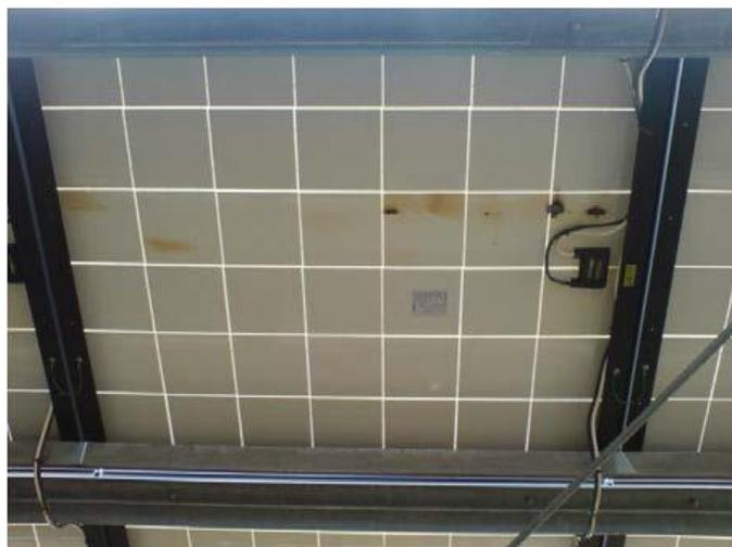
Fig. 2.2.5.5 Segni di bruciatura sul lato posteriore del modulo fotovoltaico causati da nastri di interconnessione di celle rotte.
