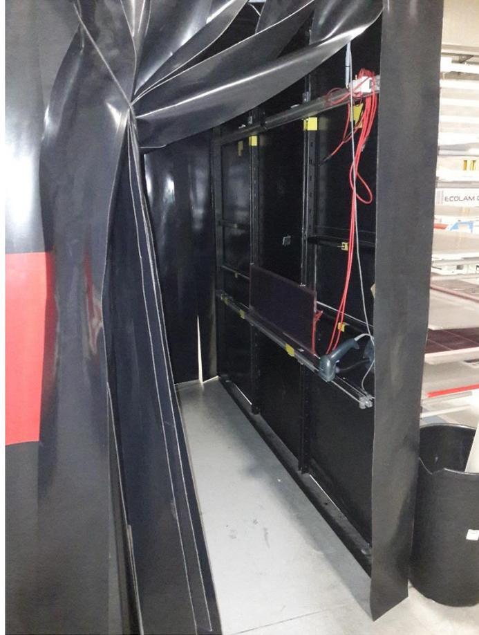
Fig. 4.2.5 Camera per la misurazione della curva I-V.
