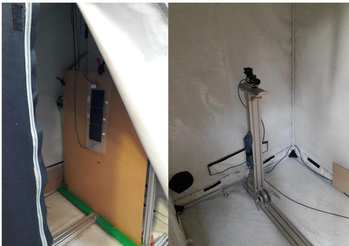
Fig. 4.2.1 Test di elettroluminescenza: a sinistra, camera buia con un modulo sotto test; a destra, fotocamera per l'acquisizione di immagini EL.
