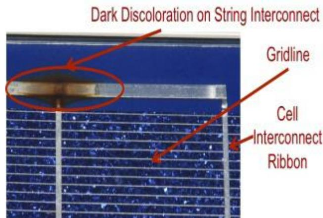
Fig. 2.2.4.1 Segni di bruciatura nella parte anteriore del modulo, scolorimento dell'incapsulante associato al surriscaldamento lungo le interconnessioni metalliche.
