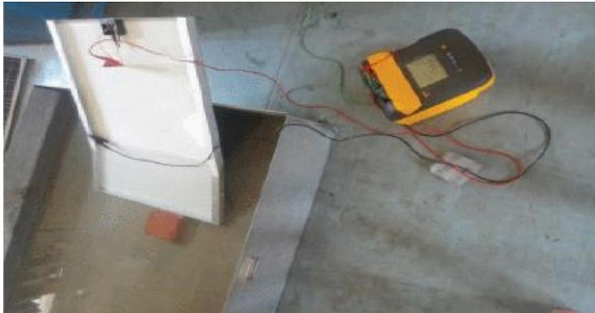
Fig. 3.3.2 Test per la misura di isolamento elettrico in condizioni di umidità.
