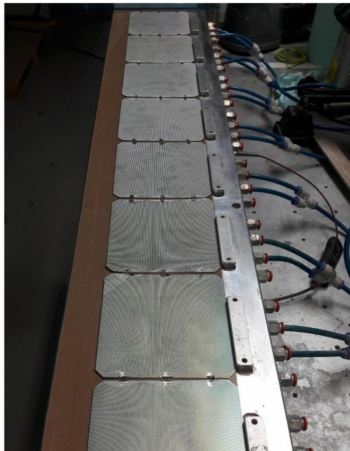
Fig. 4.3.5 Bancone di saldatura con celle pronte per essere unite in serie. A destra notare i tubi di aspirazione dell'aria.
