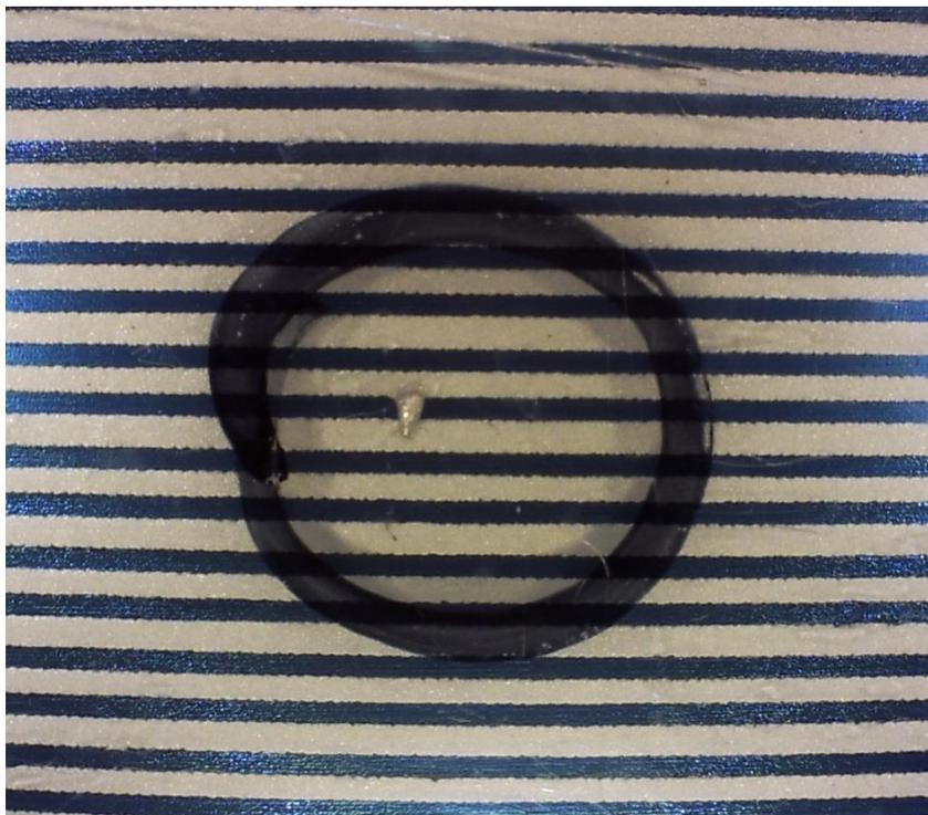
Fig. 4.3.19 Ingrandimento dell'impurità di fig. 4.3.17. Notare come unisce le due strisce bianche che rappresentano i contatti di polarità opposta.
