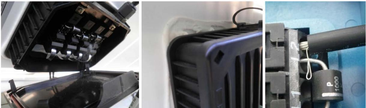
Fig. 2.1.3.1 Guasti alla *junction box*. La foto a sinistra mostra una *junction box* aperta, quella centrale un *junction box* mal posta sul *back sheet* e quella a destra un *junction box* con cablaggio mal eseguito.
