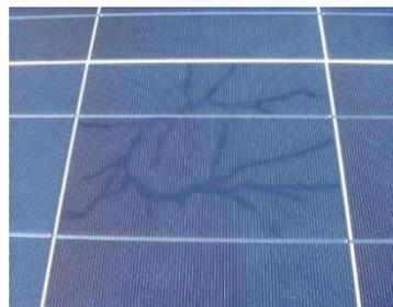
Fig. 2.2.3.1 Esempio di *snail trails* su un modulo FV.
