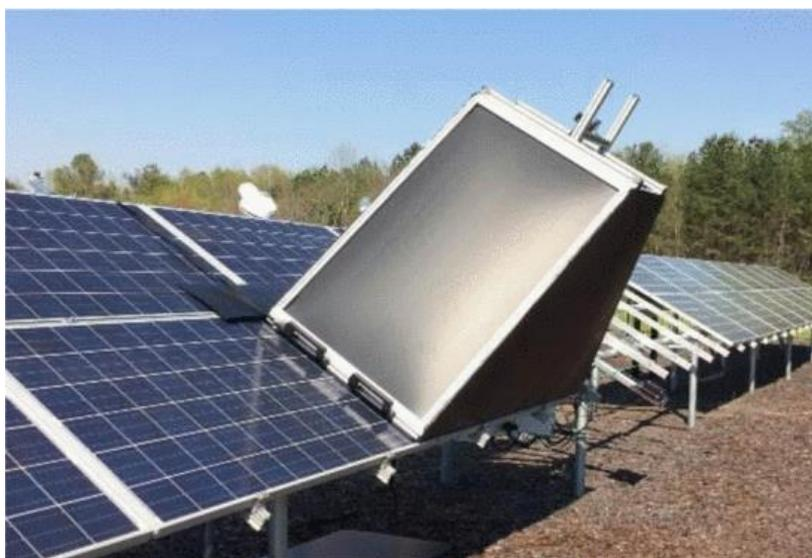
Fig. 3.5.1 Schermo protettivo dalla luce solare per effettuare il testo di EL anche su moduli installati all'aperto.
