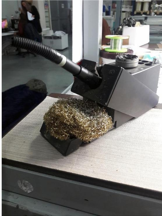
Fig. 4.3.12 Paglietta metallica utilizzata nella pulitura della punta del saldatore.
