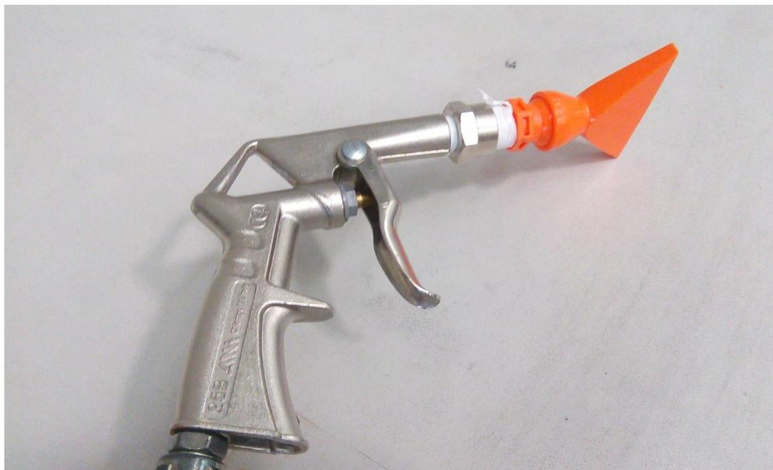
Fig. 4.3.20 Ugello a testa piatta impiegato per la pulizia delle stringhe prima di essere laminate.
