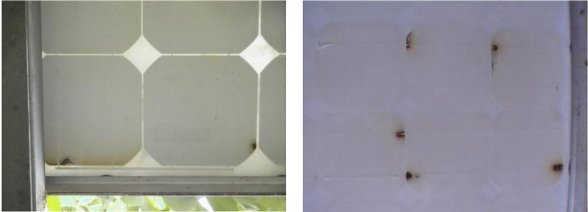
Fig. 2.2.6.3 Segni di bruciatura causati da diodi di *bypass* a circuito aperto.
