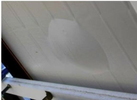
Fig. 2.1.2.2 Creazione di bolle sul *back sheet* di un modulo.
