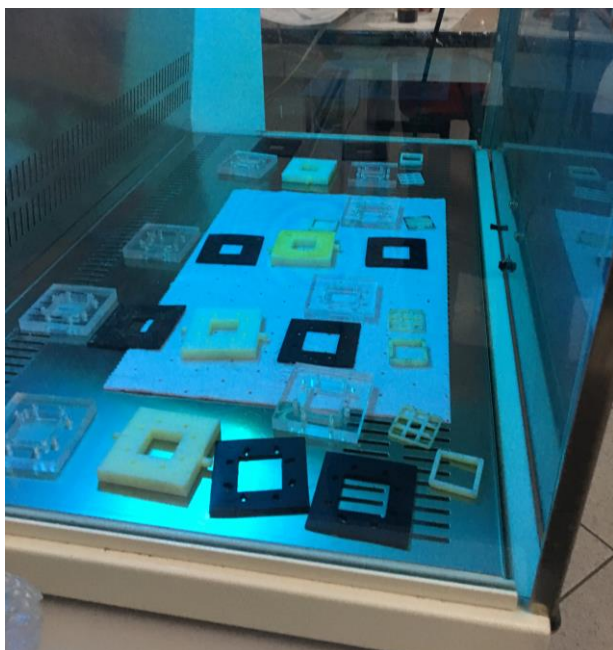
Figura 3.7: Componenti costitutive di quattro MFC single chamber durante la sterilizzazione tramite lampada UV in dotazione a una cappa biologica a flusso laminare
