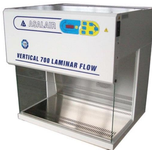
Figura 3.6: cappa a flusso laminare [70]
