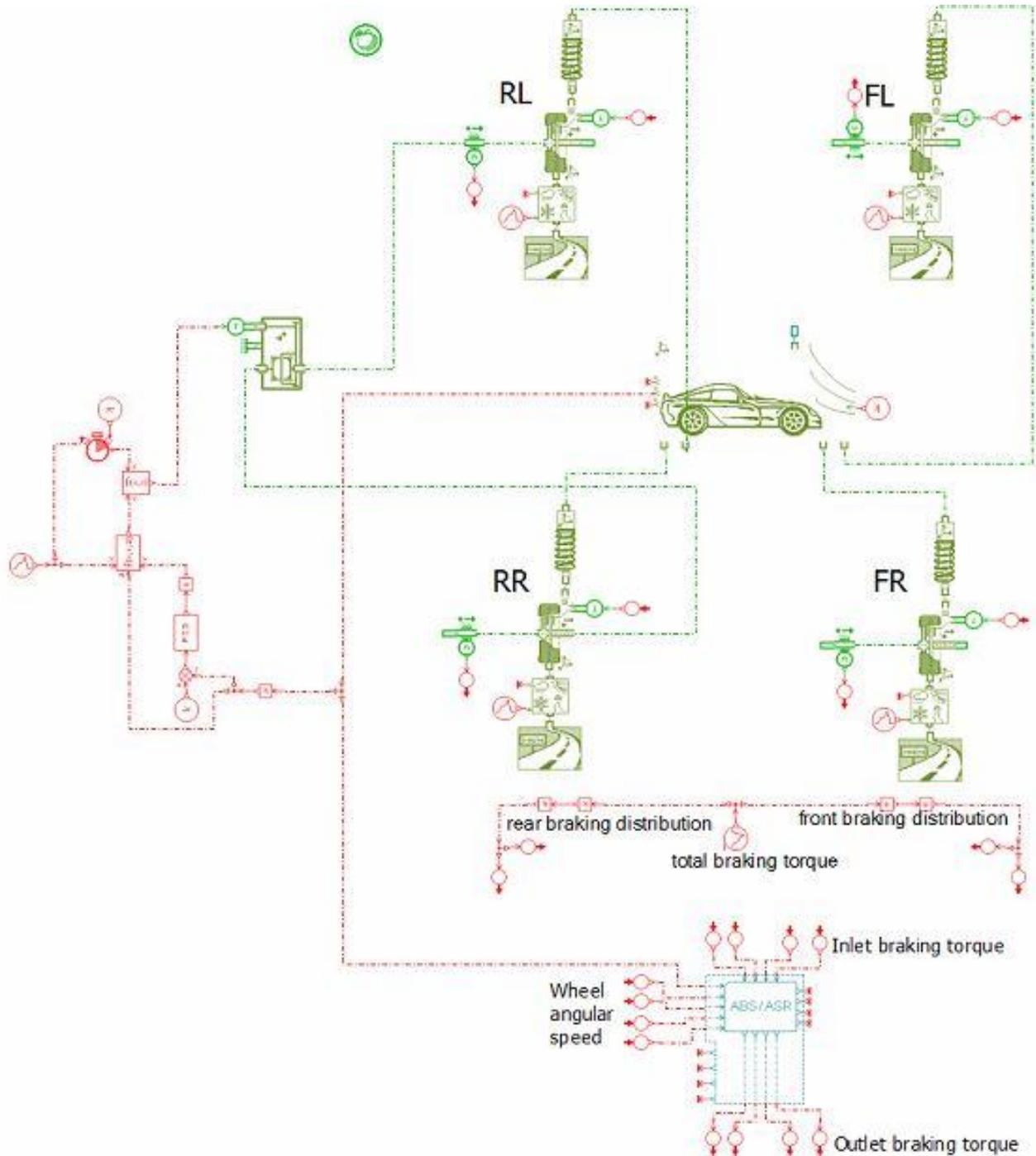
Figure 2.11 – Longitudinal model.
