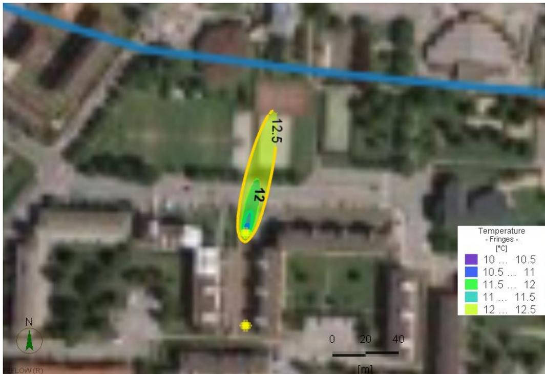
Figura 51 Impatto termico sulla 4<sup>o</sup> slide considerando una conducibilità idraulica pari a  $K_z=0.0005 \text{ ms}^{-1}$ , descritto dalle isoterme  $12^\circ\text{C}$  e  $12.5^\circ\text{C}$
