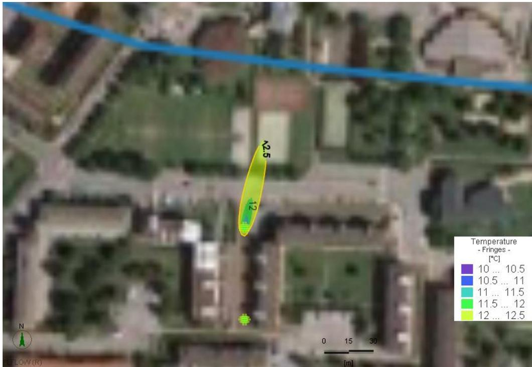
Figura 49 Impatto termico sulla 4°slide considerando una conducibilità idraulica pari a  $K_z=0.00125 \text{ ms}^{-1}$ , descritto dalle isoterme  $12^\circ\text{C}$  e  $12.5^\circ\text{C}$
