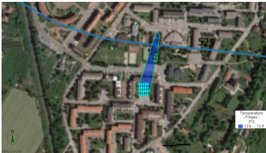
Figura 59 Plume termico in corrispondenza dell'acquifero, durante il giorno di riscaldamento più gravoso (3382 giorno)
