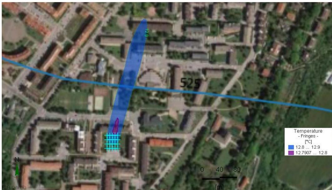
Figura 62 Plume termico in corrispondenza dell'acquifero, durante il giorno di riscaldamento più gravoso (3382 giorno)
