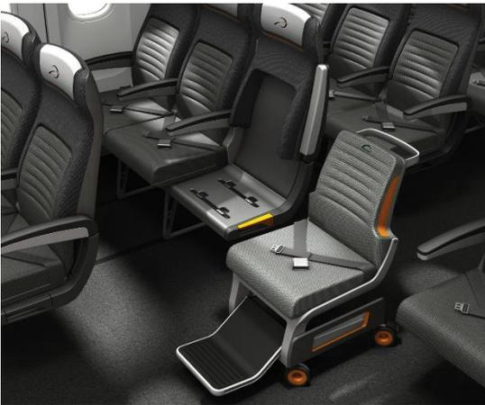
Posta è un dispositivo che aiuta il trasferimento di un passeggero su sedia a rotelle nel suo posto. Integra il cuscino del sedile dal sedile dell'aereo con il dispositivo eliminando qualsiasi sollevamento a bordo del passeggero. Una volta che il passeggero è trasferito sul dispositivo, vengono quindi trasportati sull'aeromobile e posizionati accanto al sedile, una rotaia di guida dal dispositivo quindi si ripiega
