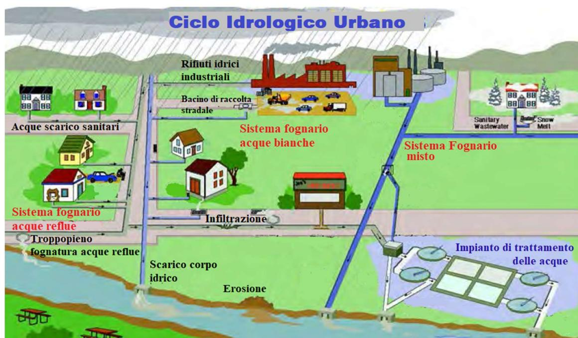
Figura 3. 1 : Elementi che fanno parte di un tipico sistema di drenaggio urbano.
