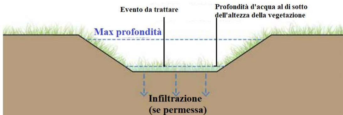
**Figura 2. 9** : Schematizzazione di un swale system [6].
