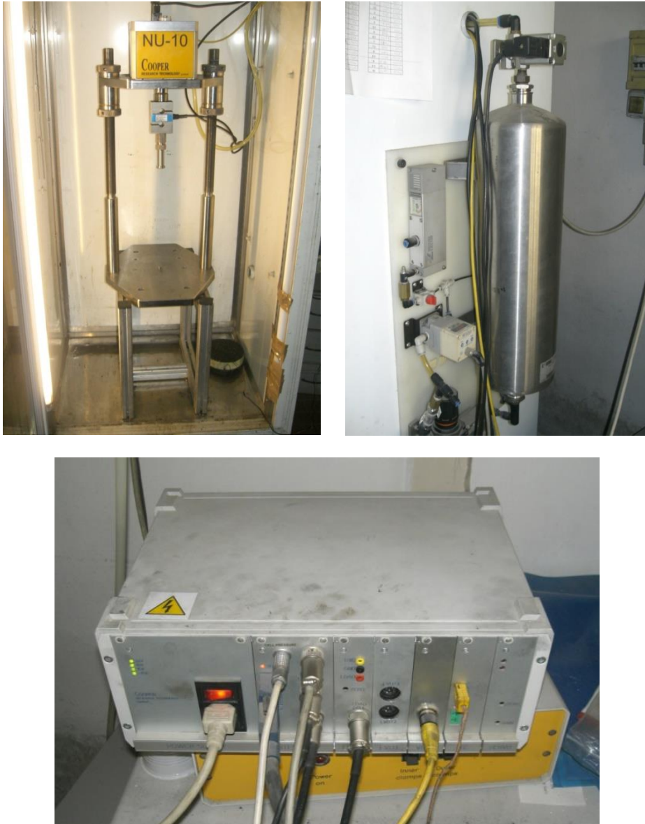
Figura 5.4: Struttura di carico del NAT; Unità pneumatica; Unità di acquisizione dati e controllo
