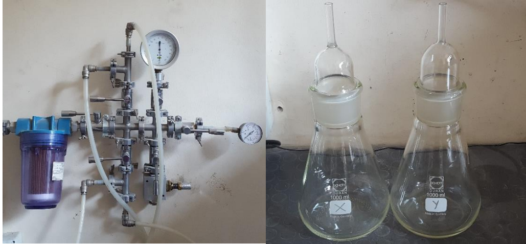
Figura 4.6: Impianto a vuoto; Picnometri corredati di tappi
