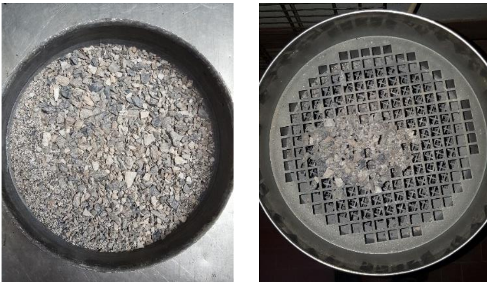
Figura 4.5: Aggregati spogli prima della setacciatura; Preparazione del test
