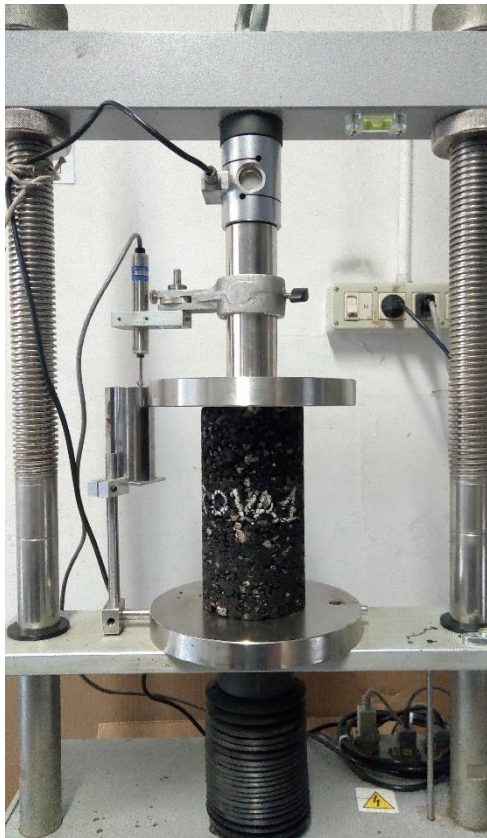
Figura 5.16: Esecuzione prova di compressione semplice; Campione portato a rottura
