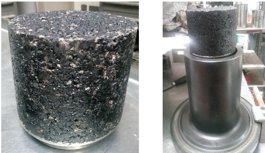
Figura 4.13: Campione di RAP compattato con la pressa giratorio; Estrusione del campione
