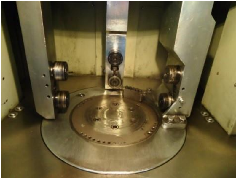
Figura 4.11: Alloggiamento della fustella nella pressa giratoria
