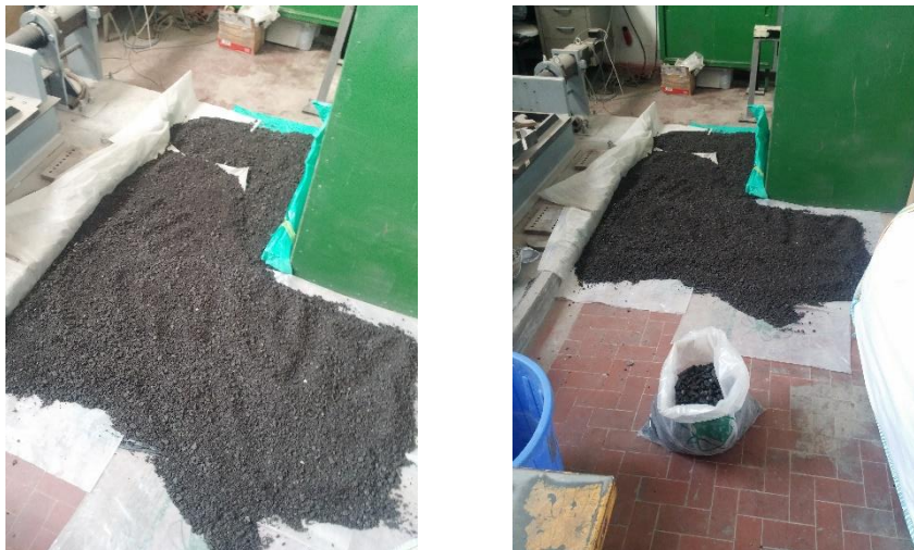
Figura 4.2: Cumulo di RAP steso per favorire l'essiccazione
