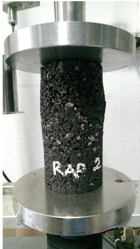
Figura 5.16: Esecuzione prova di compressione semplice; Campione portato a rottura
