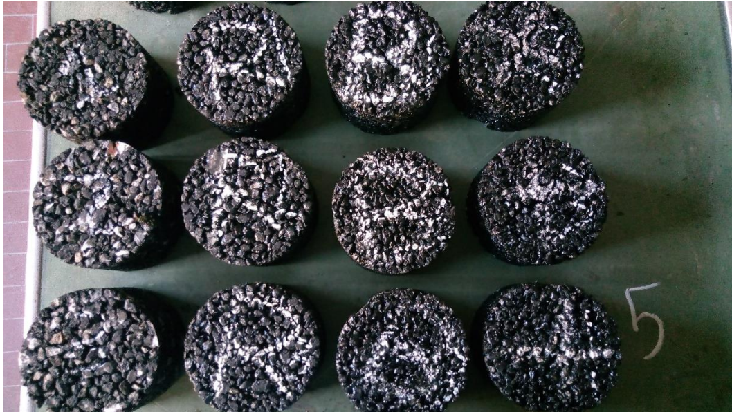
Figura 5.2: Campioni da 65 mm contrassegnati in bianco per indicare il tipo di materiale
