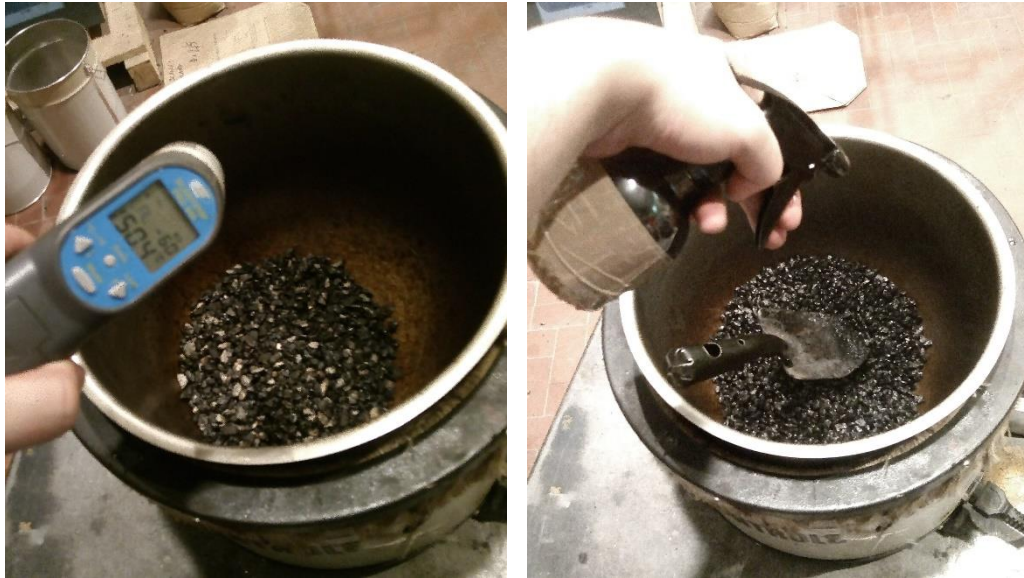
Figura 4.10: Monitoraggio della temperatura; miscelazione del RAP con Rejuvenator
