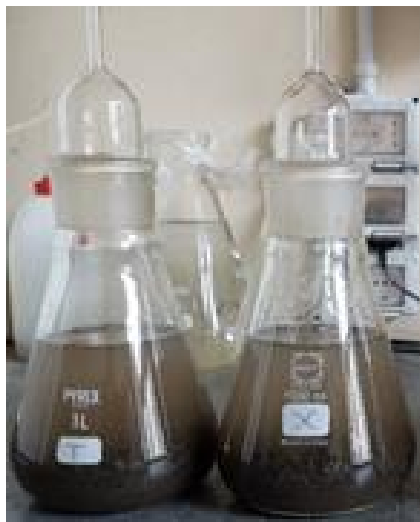
Figura 4.7: Picnometri contenenti il campione appena deaerato
