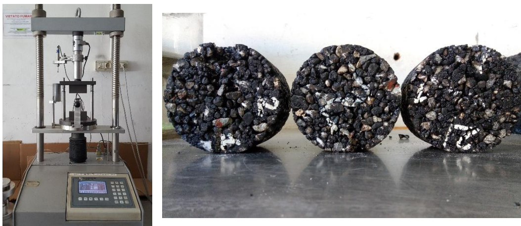
Figura 5.13: Pressa statica; Campioni sottoposti alla prova di trazione indiretta
