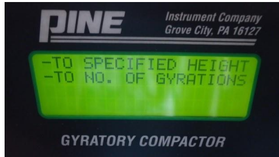
Figura 4.12: Interfaccia per il settaggio della modalità di compattazione
