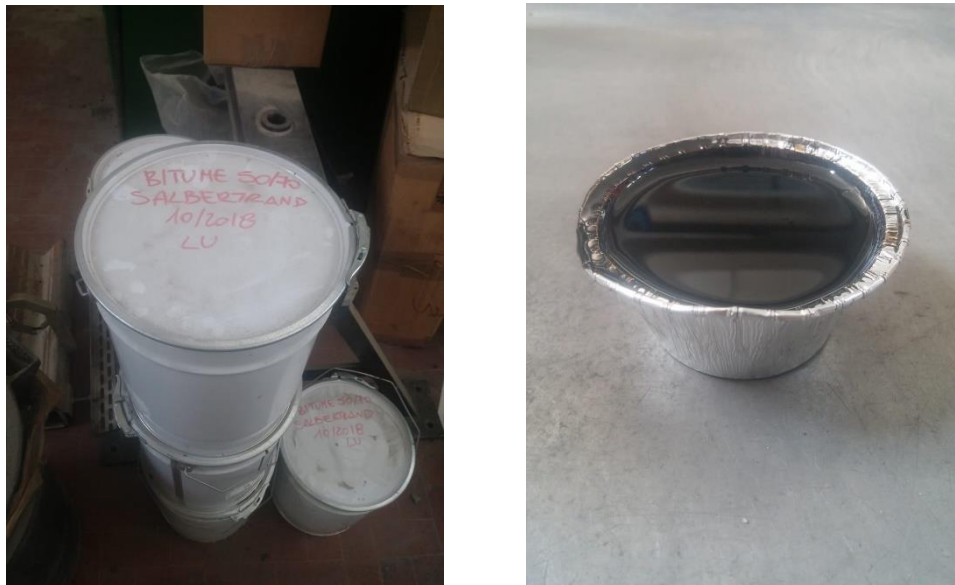
Figura 4.16: Stoccaggio del bitume vergine
