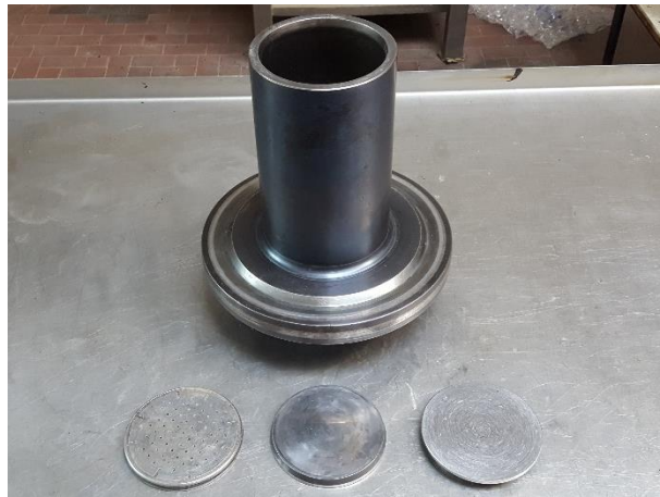
Figura 4.9: Fustella per la pressa giratoria
