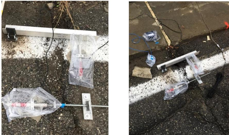
**Figura 91.** LVDT in prossimità dei giunti (Setup 1 e Setup 1 bis).
