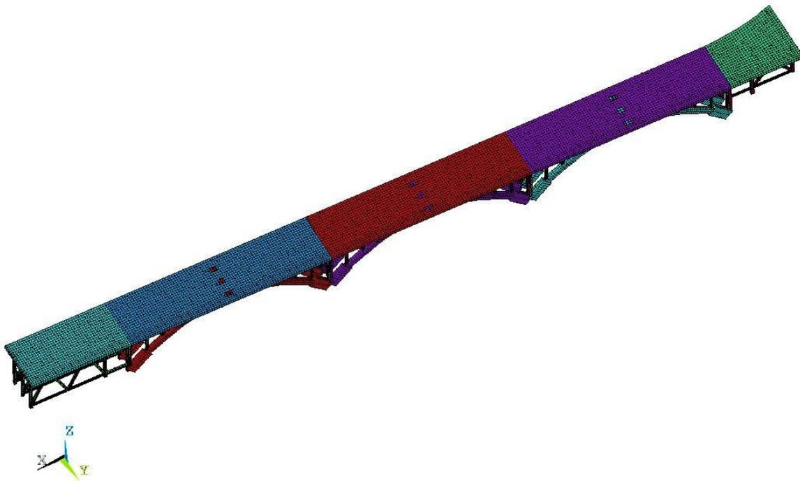
**Figura 61.**FEM Ponte Lamberti continuo senza giunti.
