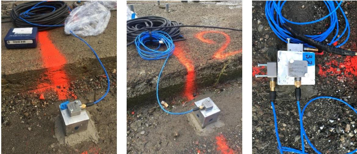
Figura 85. Cubetti con accelerometri da 1 a 3 (posizioni comuni).
