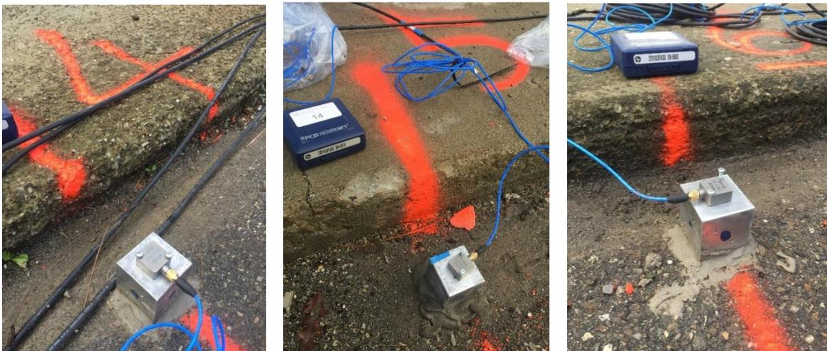
Figura 86. Cubetti con accelerometri da 4 a 6 (posizioni comuni).
