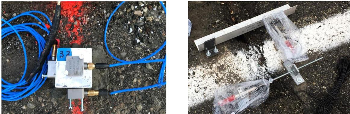
Figura 77. Accelerometri mono-assiali PCB Trasduttori LVDT.
