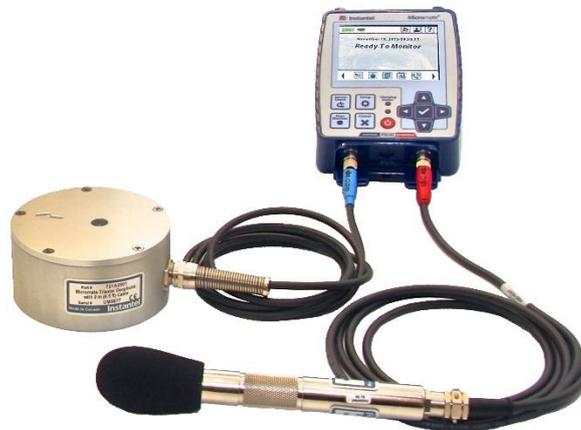
Figura 31: Elementi di misura collegati al MicroMate
