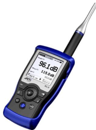
Figura 5: Fonometro per la misura del rumore
