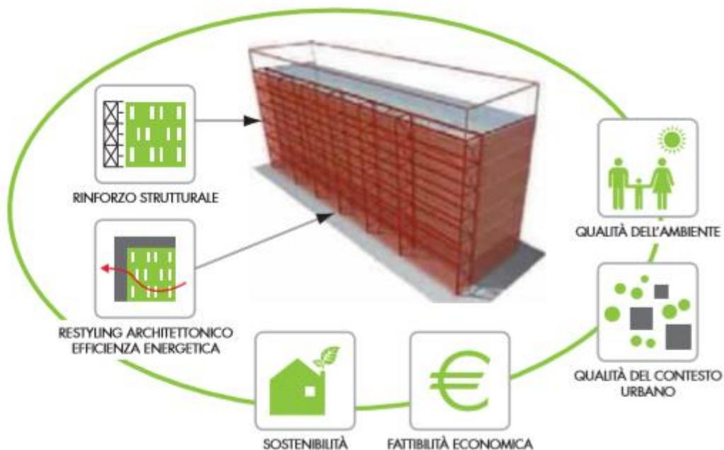
**Figura 8.** Rappresentazione schematica della soluzione a doppio involucro [Feroldi et al., 2014]
