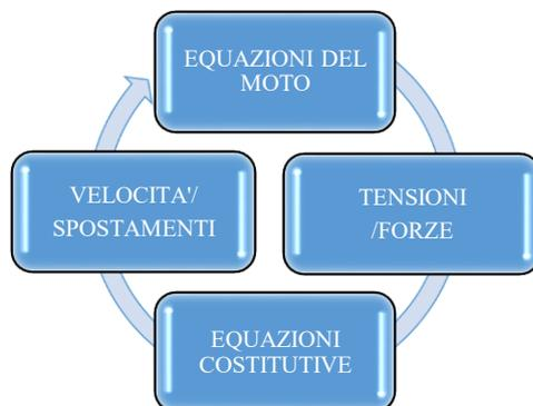
Figura 24-schema operativo del metodo alle differenze finite.
