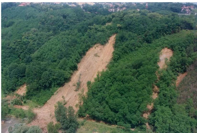
*Figura 7- Soil slip con totale asportazione della copertura boschiva innescatasi durante l'evento del 1° giugno 1992 presso i viadotti stradale e ferroviario che sovrappassano il F. Olona (VA)(Archivio IRPI-CNR Torino).*
