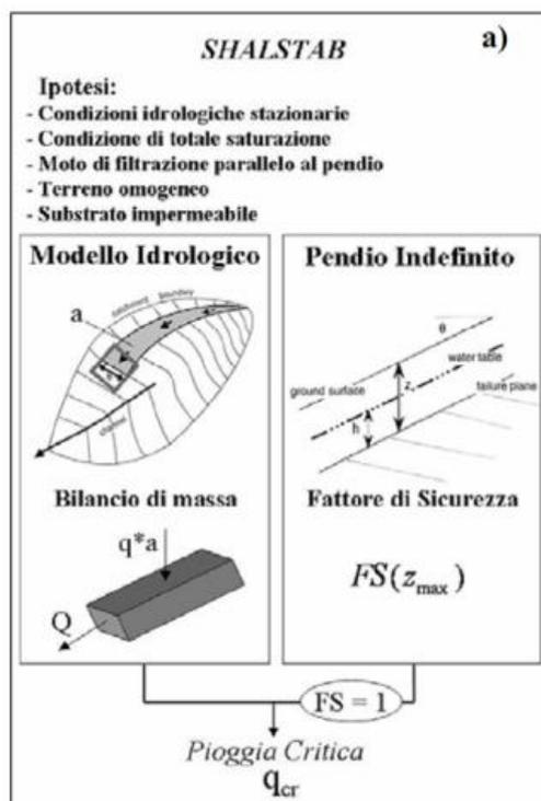
Figura 10-Schema del modello SHALSTAB. (Sorbino, Sica, Cascini Cuomo)
