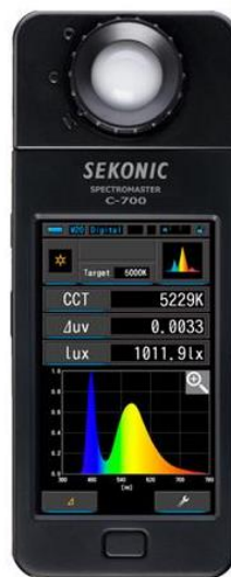
Figura 14 – Lo spettrometro Spectromaster-C700 utilizzato nelle misurazioni. Immagine di cortesia dal sito Sekonic
