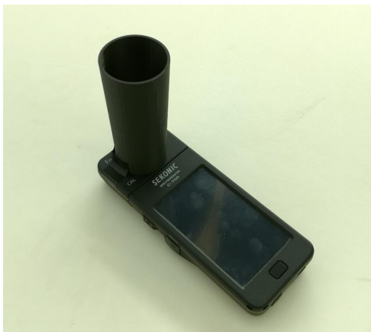
Figura 68 – Tronco di cono stampato in 3D equipaggiato sullo spettrometro Sekonic al fine di simulare l'angolo solido della fotocamera Andor Zyla
