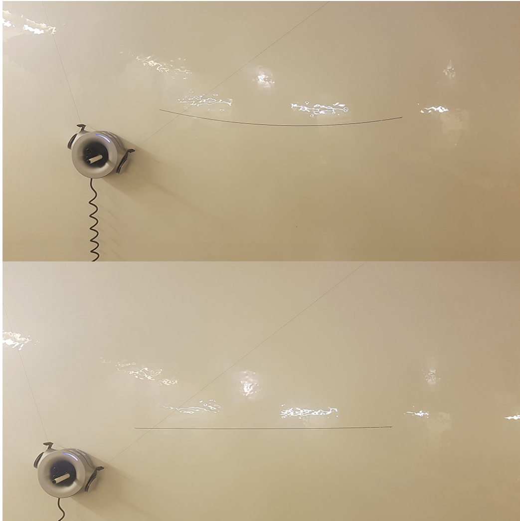
Figura 31 - Sopra: linea orizzontale distorta. Sotto: stessa linea con l'algoritmo di compensazione della distorsione
