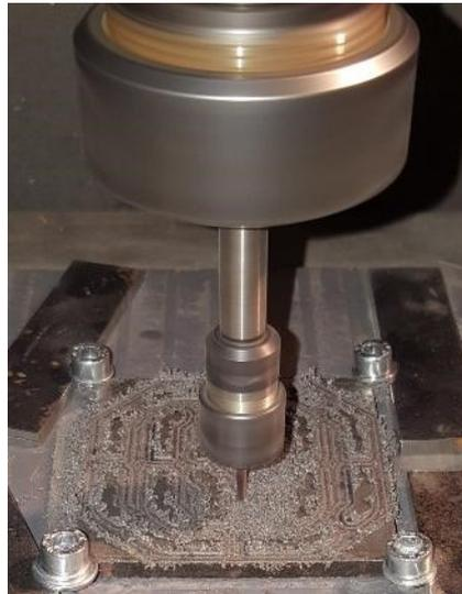
Figura 3.42: Campione di CPPA6-10 durante fresatura
