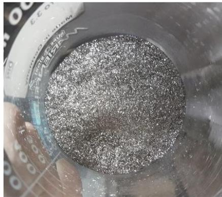
Figura 3.1: Esempio di polvere metallica usata per realizzare un magnete (NdFeB) [6]
