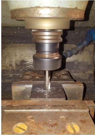
Figura 3.11: Spianamento di un campione con la fresatrice
