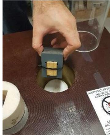
(b) Posizionamento del blocco di plastica all'interno della bobina del magnetizzatore
