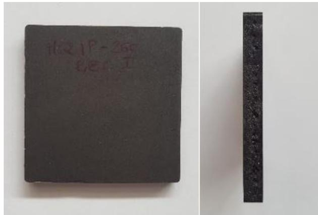
Figura 3.8: Primo campione stampato di MQIP-M260, si noti la porosità sulla superficie laterale
