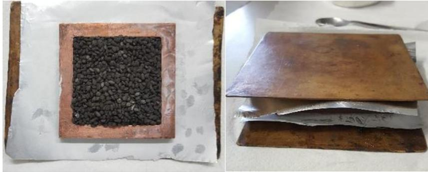
Figura 3.5: Disposizione del prodotto nello stampo e preparazione allo stampaggio
