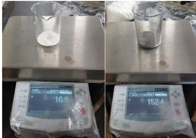
Figura 3.34: Pesatura di PA 6 e MQP 14-12
