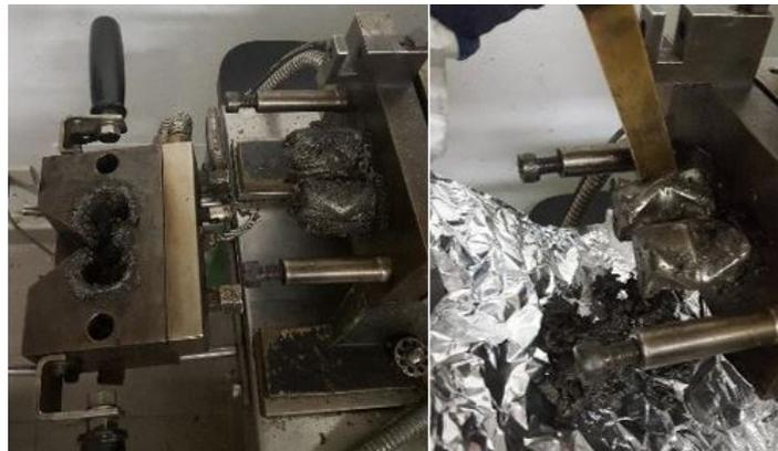
Figura 3.37: Rimozione del materiale dal mixer
