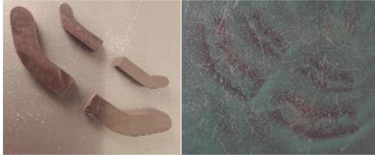
Figura 3.30: Campioni di FB23 magnetizzati e relative linee di flusso
