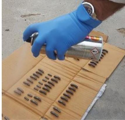
Figura 3.16: Copertura dei tegolini con spray protettivo
