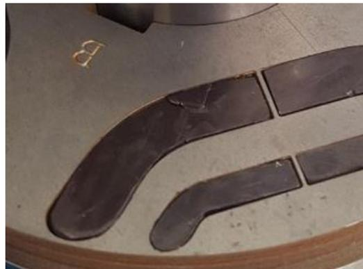
Figura 5.5: Campione di FB23 crepato durante l'assemblaggio
