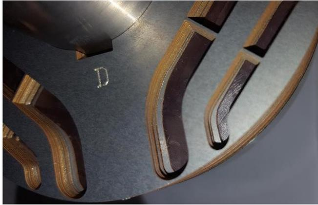
Figura 5.6: Dettaglio sullo skewing
