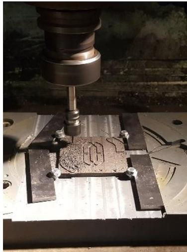
Figura 3.14: Fresatura di un campione di MQIP-M260
