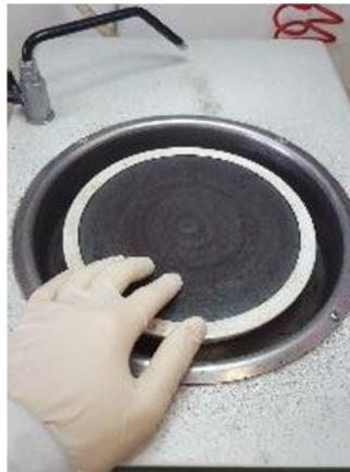
Figura 3.31: Lucidatrice per metalli utilizzata per limare la superficie attorno ai magneti
