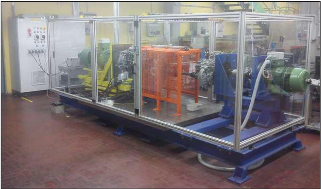
**Figura 1.1** – *Banco prova trasmissioni*
