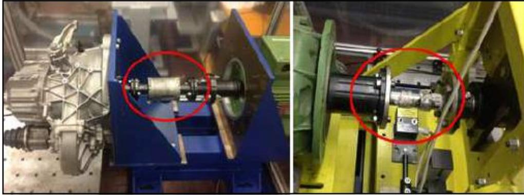
**Fig.1.4** – a) Torsiometro motore 11 kW; b) Flangia strumentale motore 37 kW
