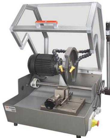
Figura 11: Troncatrice metallografica Remet TR80 Evolution
