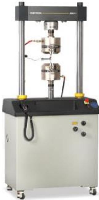
Figura 43: sistema servoidraulico di prova Instron 8801
