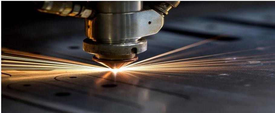
Figura 8: Taglio tramite laser di lamiera
