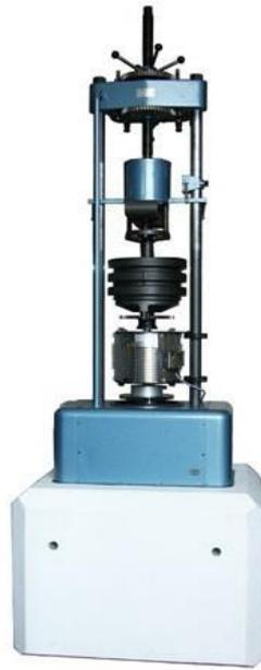
Figura 40: Vibroforo Amsler 10 HFP 422
