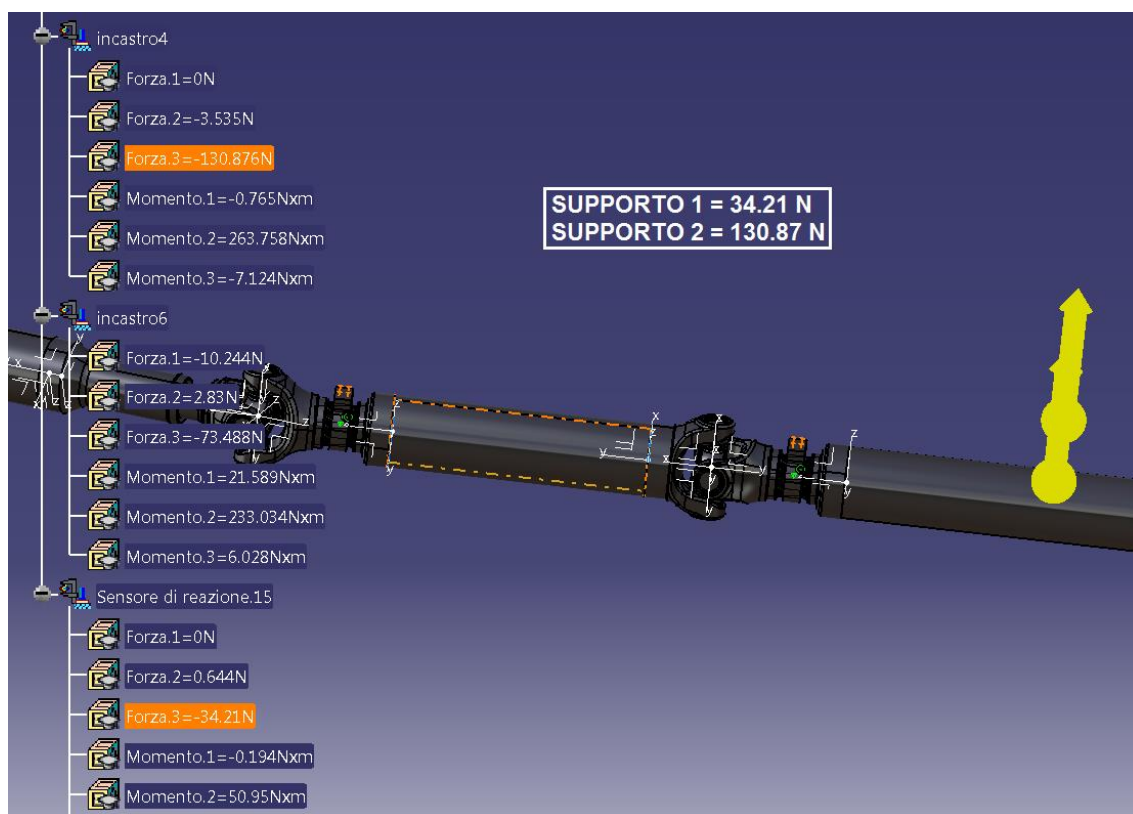
Figura 5.2-3: Risultati - analisi FEM - distribuzione masse – 3 tronchi
