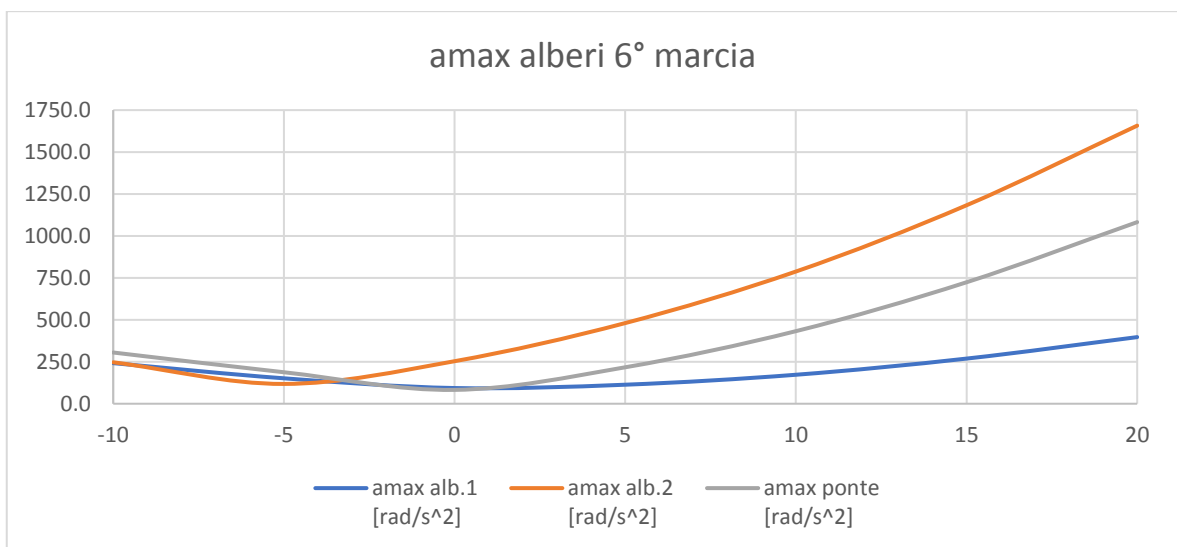
Figura 4.7.3-4: Risultati - influenza quota supporto - acc. max alberi - sesta marcia - 2 tronchi + RJ
