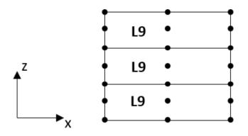
Figure 3.6: Expansion mesh - 1L9 per layer
