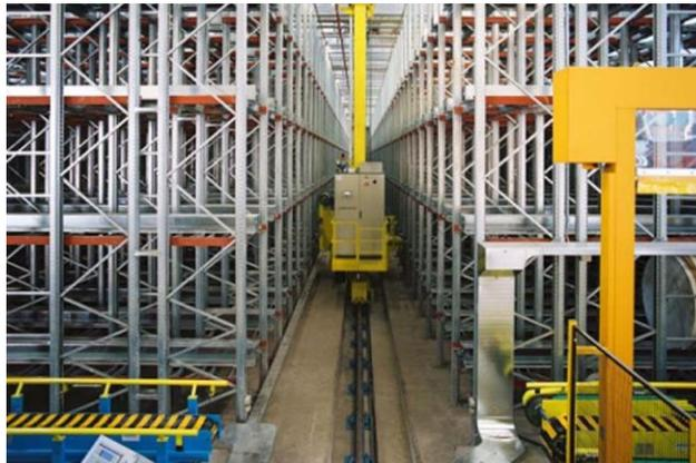
*Figura 1 Sistema con trasloelevatori*
