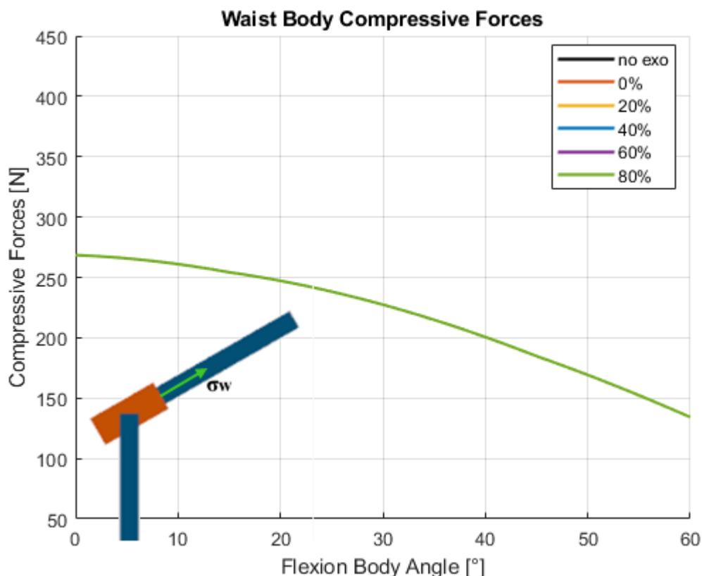
Fig. 4.20 - andamento della componente di compressione agente nel giunto waist al variare del livello di supporto
