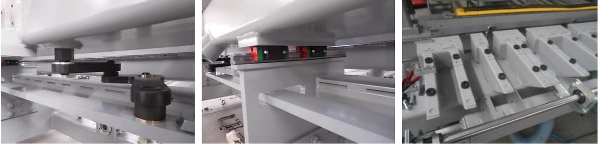
*Figura 24. Attacco del gruppo ribaltina al modulo, si vedono in ordine: leva di stacco, guide ortogonali al taglio (staccare la lastra) e plancia cuscino.*
