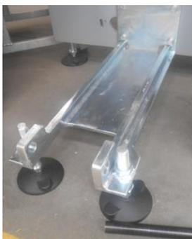
Figura 23. Staffa di supporto per la barra di troncaggio.
