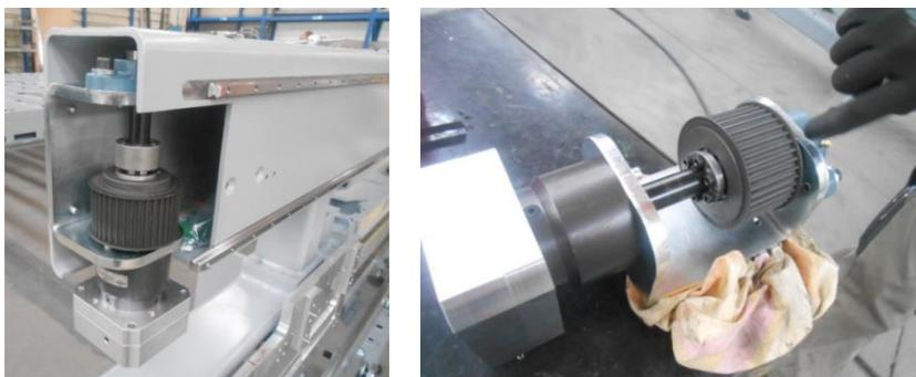
Figura 20. Sistema di movimentazione dei carrelli.
