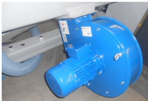
Figura 22. Ventilatori per l'aria compressa che circola nella macchina.
