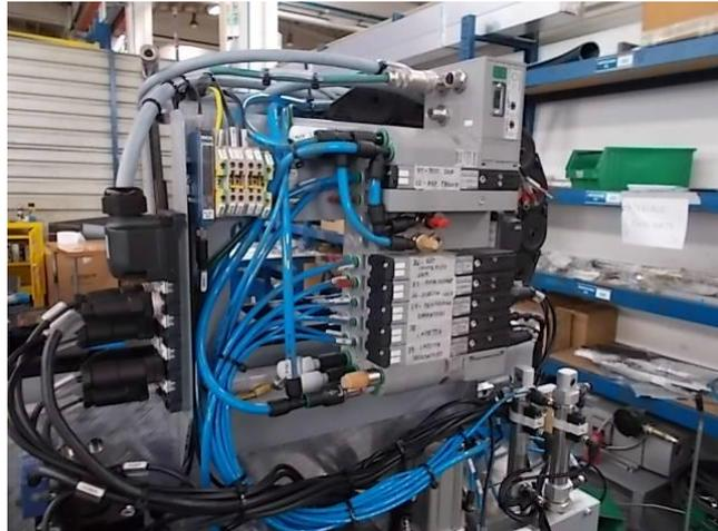
Figura 26. Cablaggio pneumatico dei carrelli, insieme di tubi e cavi che dirigono il processo di taglio.
