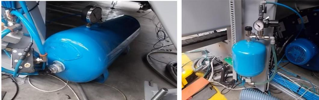
*Figura 15. Pompa del vuoto e serbatoio d'olio posti nella zona inferiore della macchina.*
