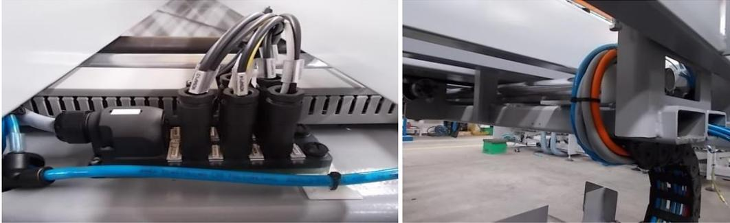
*Figura 11. Particolare delle cablature che passano lungo la trave.*
