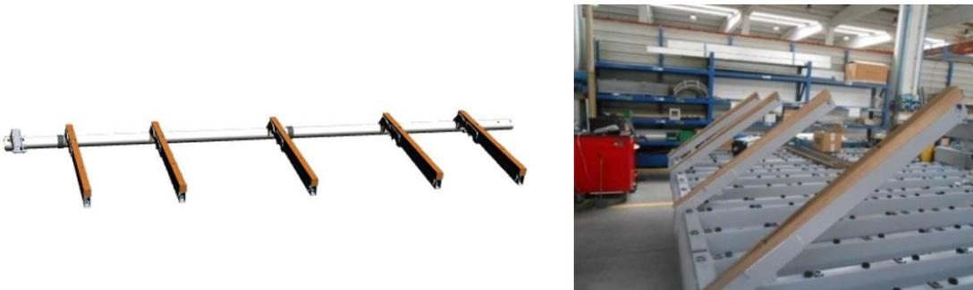
*Figura 12. Gruppo braccia di carico scarico, poste nella zona anteriore del tavolo.*
