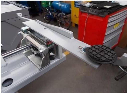
*Figura 31. Componenti del ponte di attestatura e specifica del meccanismo del gruppo rotatore.*
