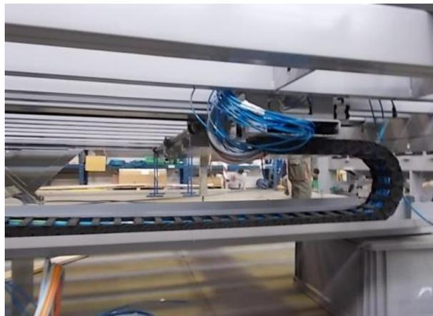
*Figura 10. Catena portacavi montata ed in fase di riposo, si nota la struttura composta che permette di seguire il ponte di attestatura lungo il tavolo.*
