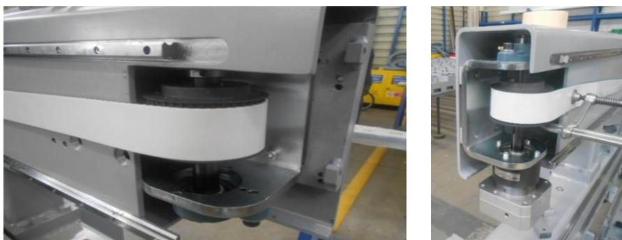
Figura 21. Settaggio cinghie di trasmissione e messa in tensione.
