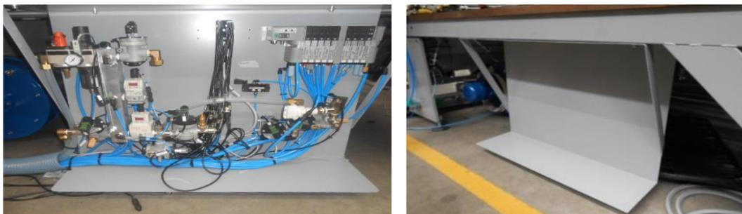
*Figura 16. Immagine del pannello di controllo pneumatico posto sul lato del tavolo e chiuso in seguito con un carter per un facile accesso in caso di manutenzione.*
