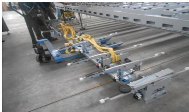
*Figura 8. Posizionamento del ponte di attestatura da parte di un operatore tramite un transpallet al di sotto del tavolo.*
