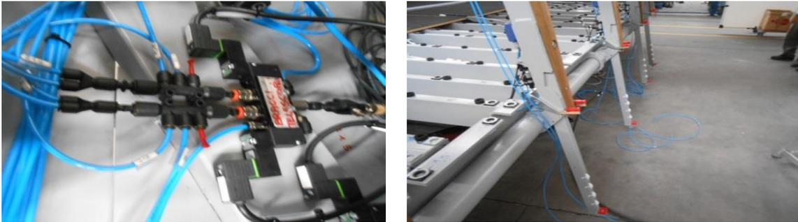
*Figura 13. Esempio collegamento tubi penumatici e cablatura braccia di scarico con i relativi braccetti uscenti.*
