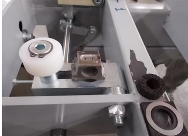
*Figura 7. Esempio dei tasselli di zero, si nota il meccanismo che ne permette l'alzata.*
