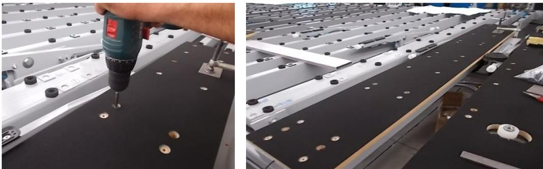
*Figura 14. Fissaggio dei pannelli in legno con feltro sul tavolo, utilizzo di un avvitatore per collegarli al tavolo nei fori prefissati.*
