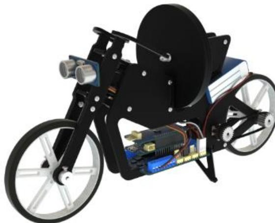
Figura 2.4.1 – Modellino del motociclo Arduino<sup>®</sup> utilizzato per le prove sperimentali [4].
