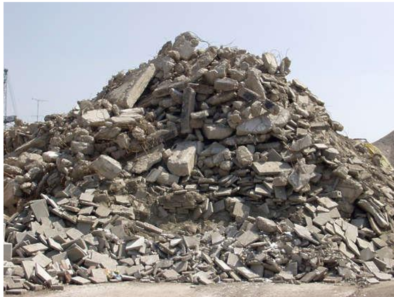
Figura 32 - Accatastamento di calcestruzzo armato proveniente da demolizione, fonte: www.bricl-a-brack.com
