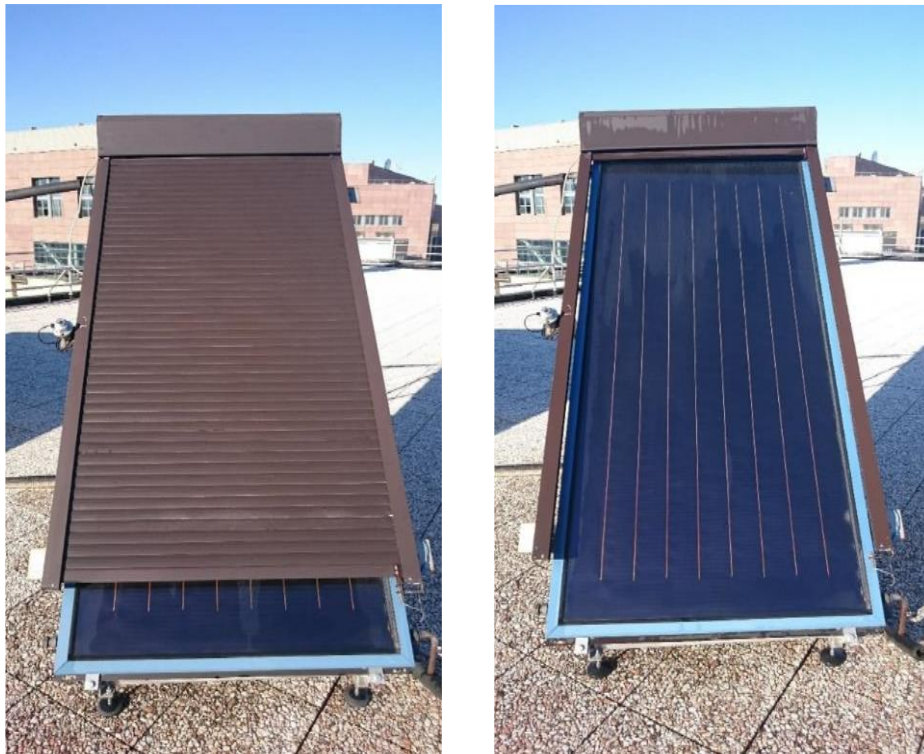
Figura 8.4 –Il collettore solare con tendina aperta e chiusa
