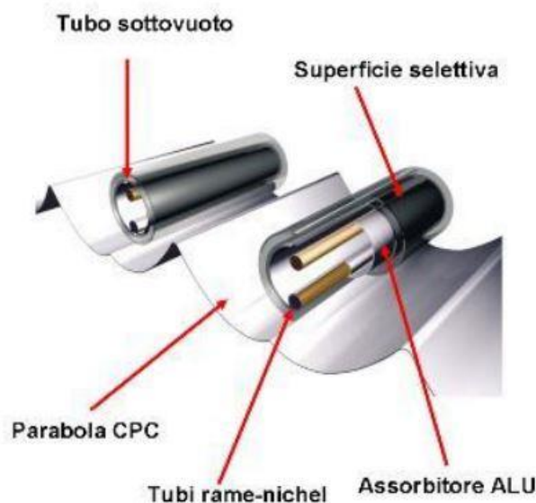
Figura 6.3 – Esempio di collettore sottovuoto (a tubi evacuanti)
