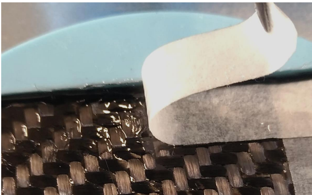
Figura 3-44 Rimozione del nastro di carta staccatosi autonomamente dal tessuto.
