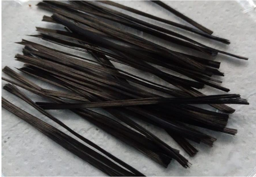
Figura 3-30 Fasci di fibre di C utilizzate per la realizzazione dei provini con fibre unidirezionali.
