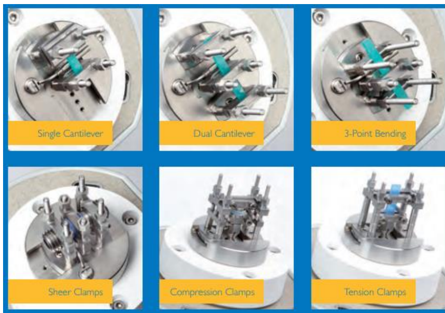
Figura 3-20 Configurazioni utilizzabili con lo strumento.
