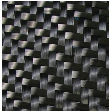
Figura 3-6 Trama del tessuto di carbonio Toray T300 2x2 Twill
