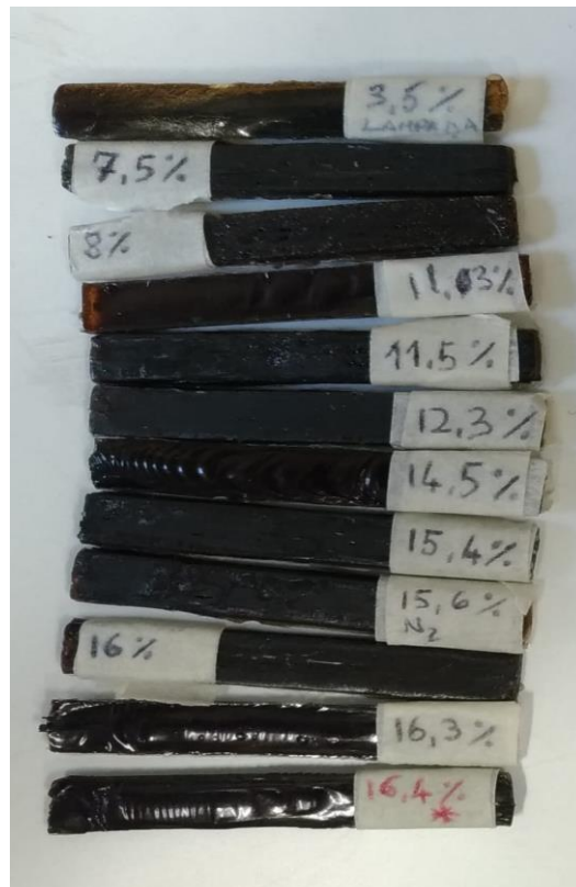
Figura 3-33 Provini con fibre unidirezionali, la percentuale visibile è il loro contenuto di fibre in peso.
