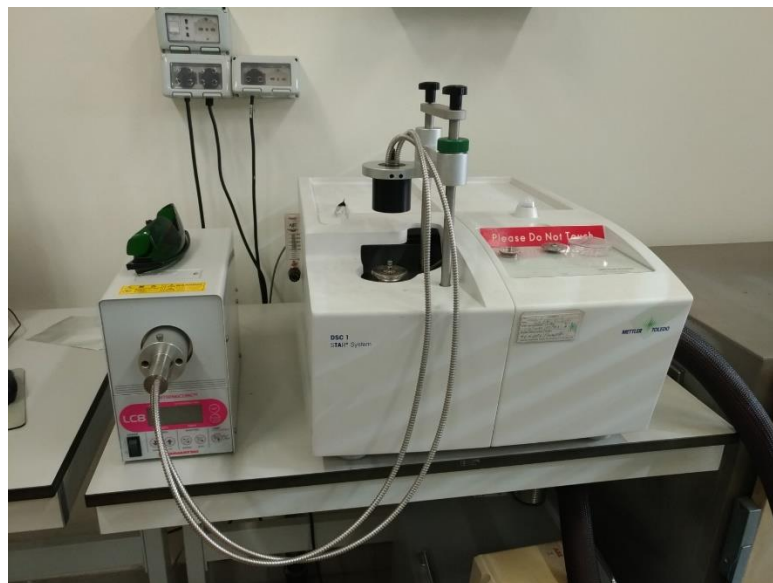
Figura 3-13 DSC1 STAR e System equipaggiata con lampada UV Hamamatsu LC8
