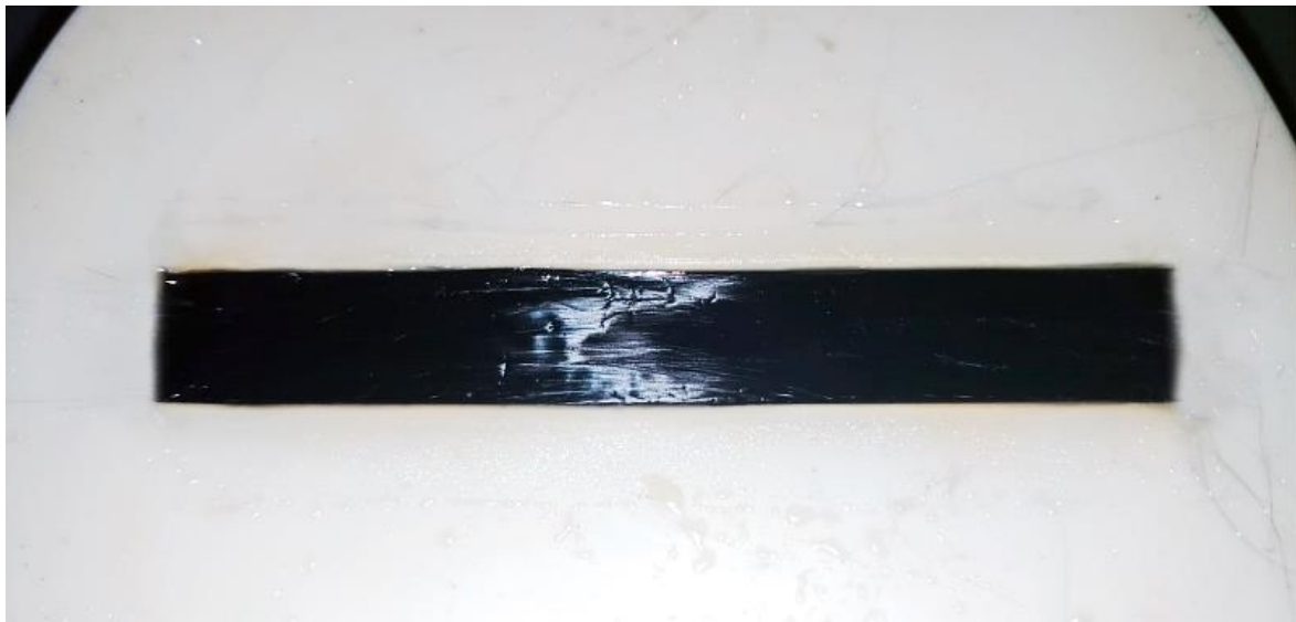
Figura 3-31 Provino con fibre unidirezionali prima della reticolazione.
