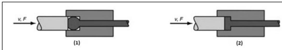
Fig.7 – Schema esemplificativo della ricalcatura prima dell'applicazione della pressione (1) e dopo l'applicazione della pressione (2)
