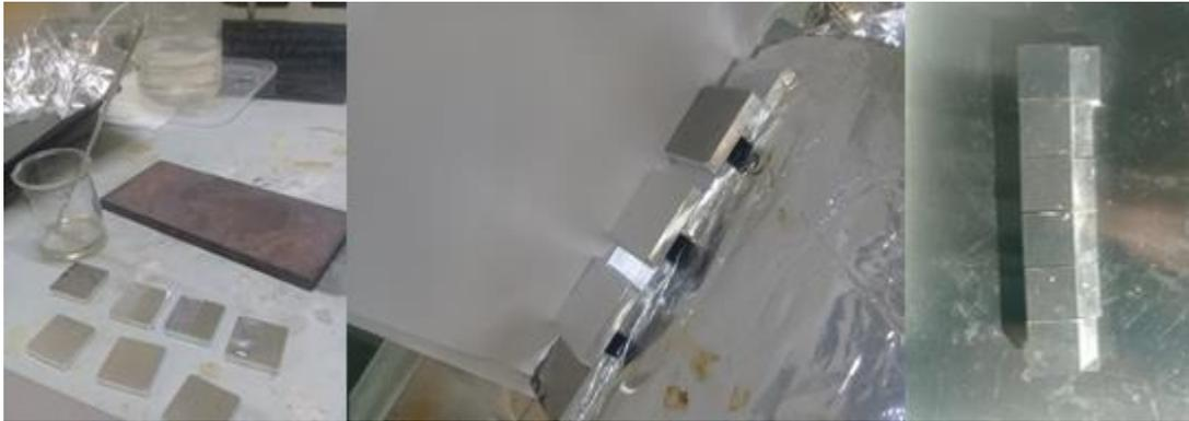
Figura 3.18. Stesura del bisfenolo sulle placche di alluminio , reticolazione e giunzioni finite
