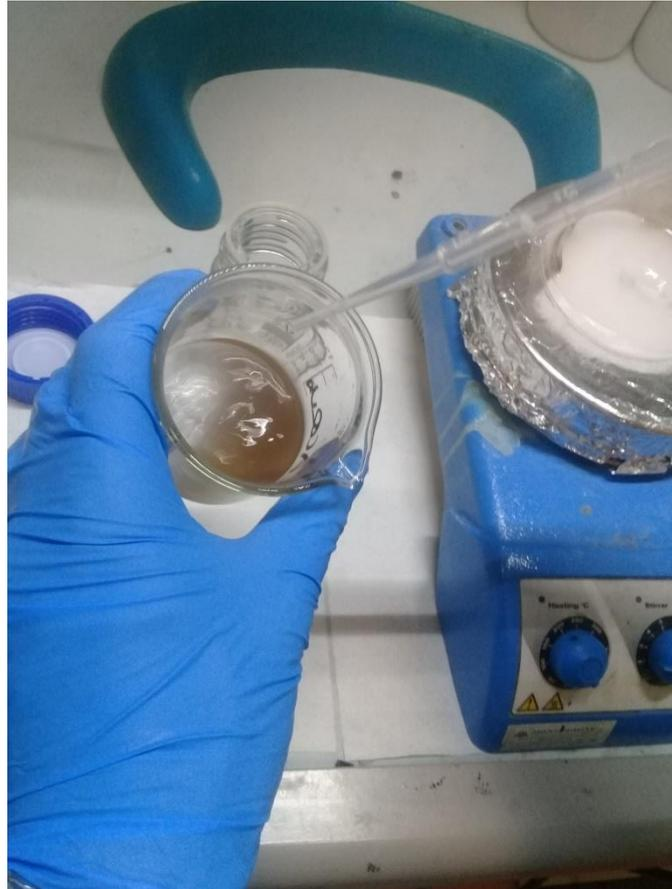
Figura 3.8. Aggiunta goccia a goccia di  $\text{NH}_4\text{OH}(\text{aq})$  in  $\text{AgNO}_3(\text{aq})$
