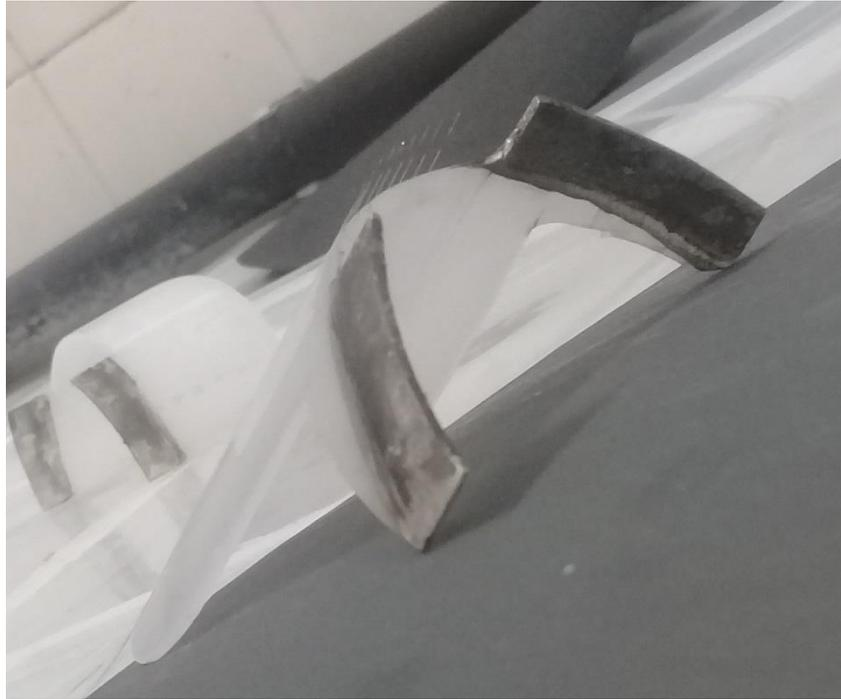
Figura 3.12. Asciugatura dello specchio d'argento
