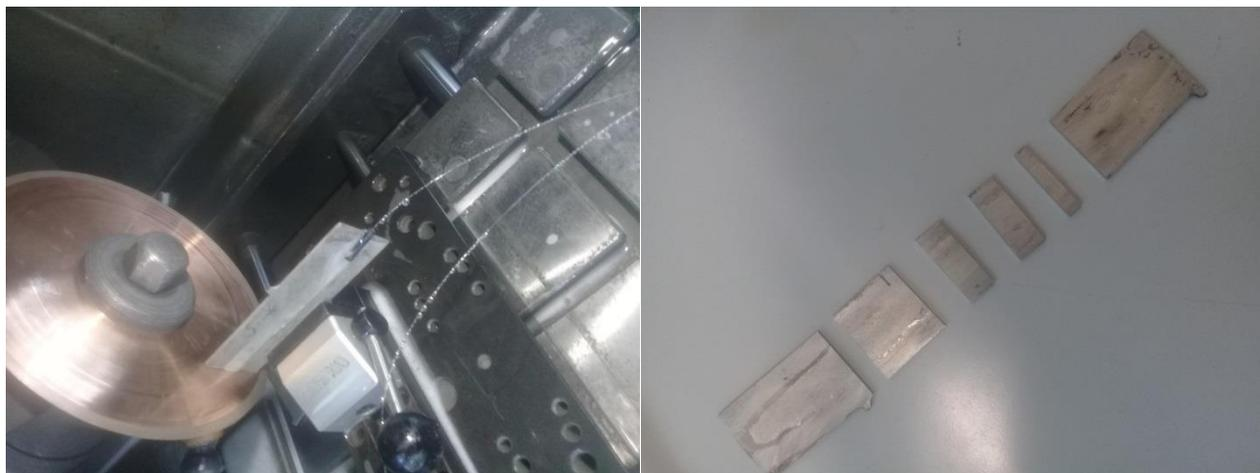
Figura 3.17. Troncatrice raffreddata ad acqua e risultato dei tagli per l'osservazione al microscopio ottico
