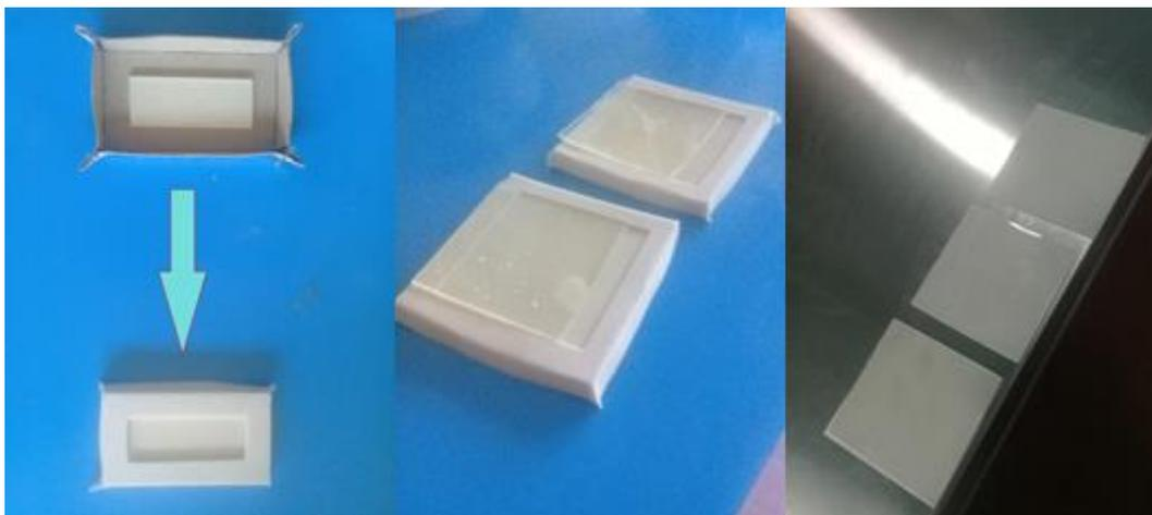
Figura 3.14. Preforma e stampo finito (sinistra), due stampi a sezione quadrata con campioni estratti (al centro), i tre campioni usati per la prova di diffusione dopo lucidatura (a destra)
