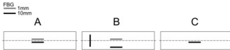
Figura 2.3<sup>[9]</sup>. Modalità di inserimento sensori FBG
