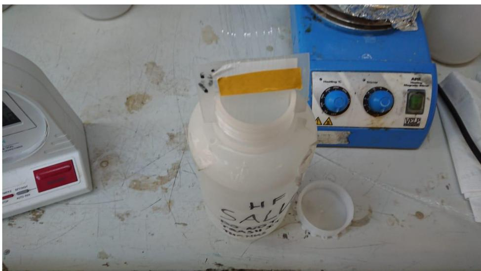
Figura 3.1. Fibre ottiche immerse in HF
