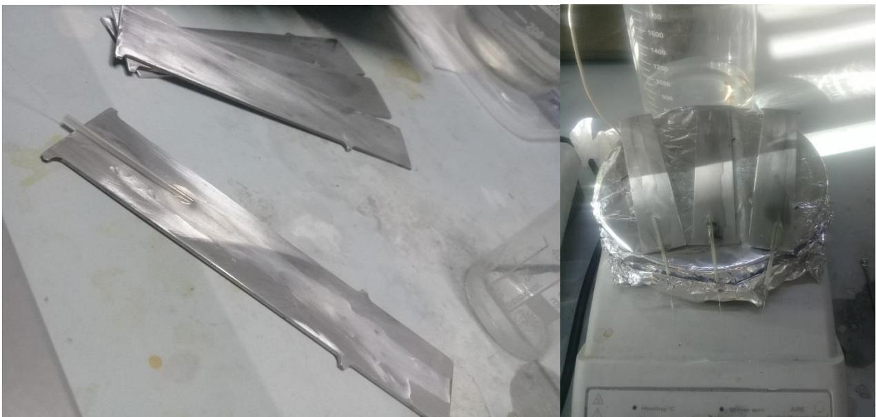
Figura 3.16. Substrati in alluminio prima e dopo embedding e reticolazione
