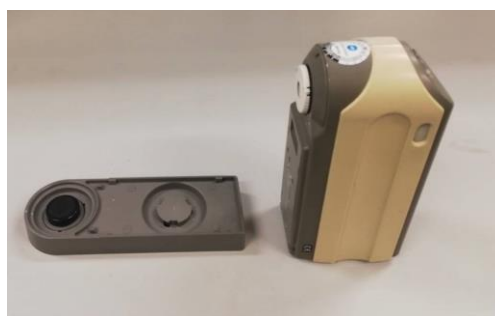
Figura 2.13: Spettrocolorimetro (Konica Minolta CM-2600d).
