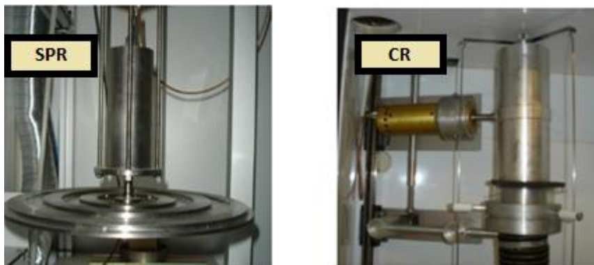
Figura 1.5: a sinistra vi è un trasduttore a piatto e a destra un trasduttore cilindrico (figura tratta da Amato, 2017, e riprodotta con modifiche)
