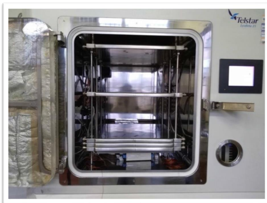
Figura 2.7 Camera interna del liofilizzatore vista frontalmente
