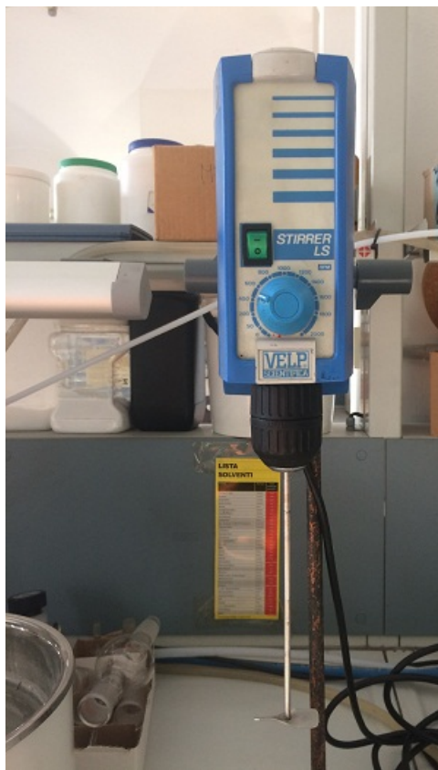
Figura 2.4: Sistema con agitatore utilizzato nell'attività sperimentale.
