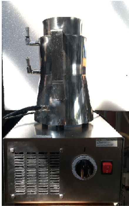
Figura 2.2: Sistema 'cup-horn' (REUSS) utilizzato nelle prove sperimentali.
