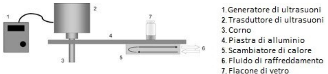
**Figura 1.3** Schema del sistema a onde ultrasonore. Tratto da [12] con modifiche.
