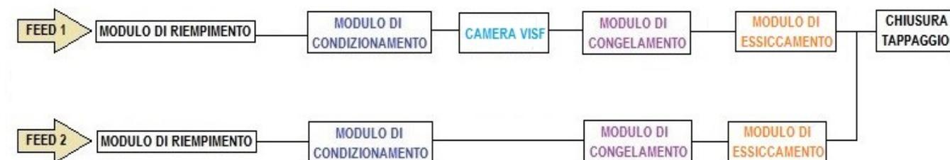
**Figura 4.4** Schematizzazione di due esempi di processi continui per la liofilizzazione di flaconi.
