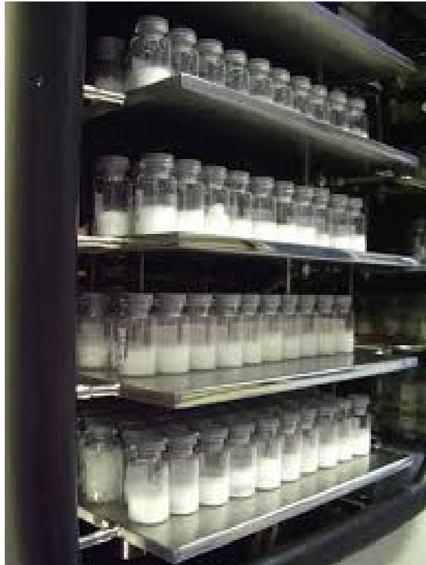
**Figura 2.1** Camera di un liofilizzatore batch con i flaconi contenenti il prodotto poggiati sopra i ripiani. Tratto da [28].
