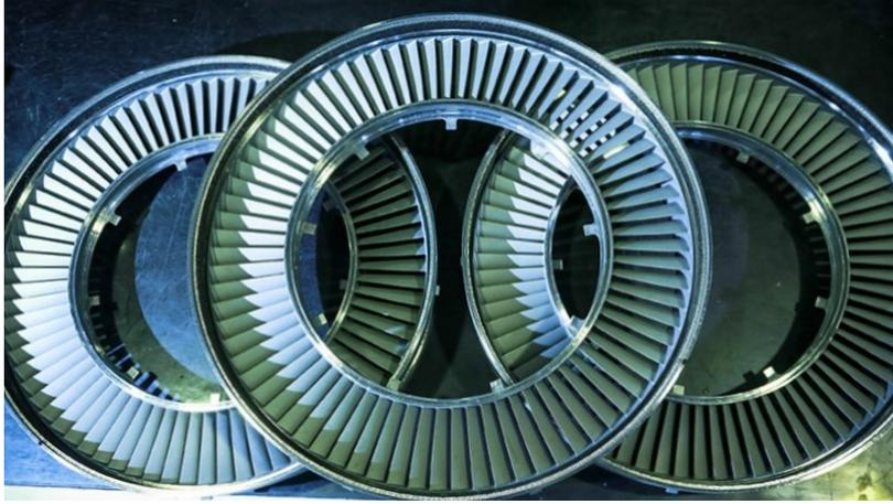
Figura 2.1: Esempio di strutture in simmetria ciclica <sup>[19]</sup>.
