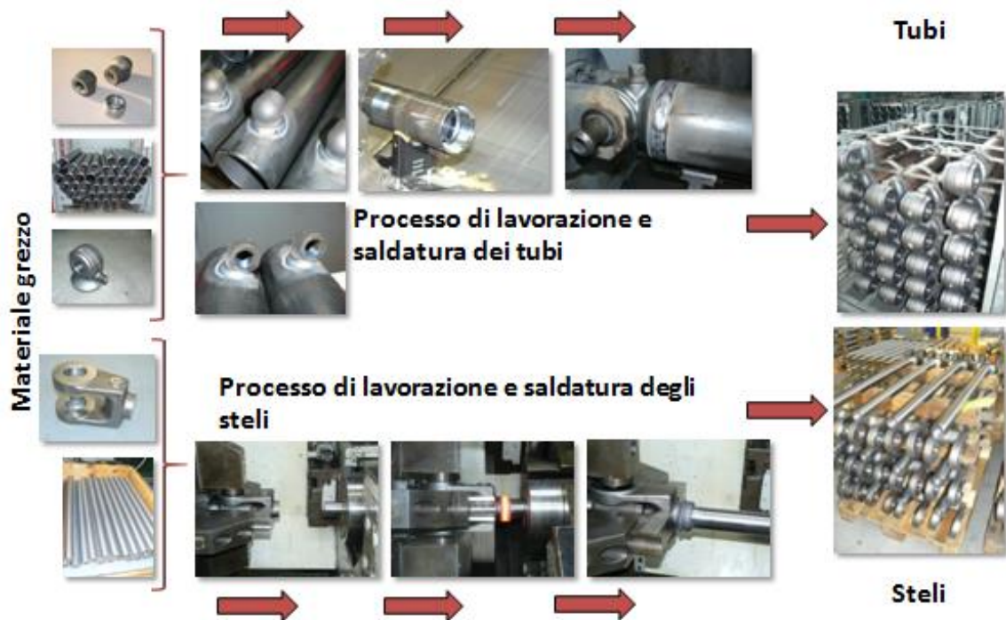
Figura 18 - Processo di lavorazione dei tubi e degli steli
