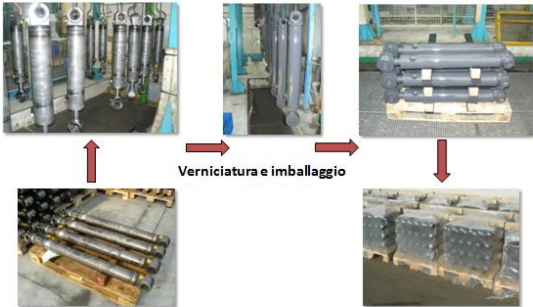
Figura 20 - Verniciatura ed imballaggio dei cilindri idraulici
