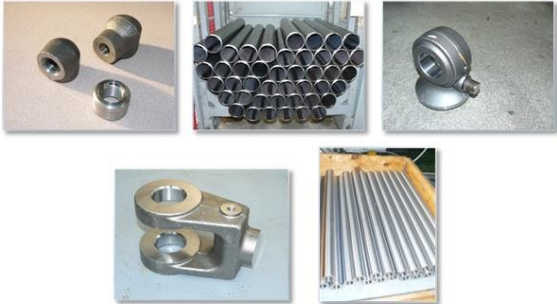
Figura 17 - Componenti grezzi. Partendo dall'alto a sinistra: borchie a saldare, tubi, attacco ad occhiello dei tubi, attacco ad occhiello degli steli, steli
